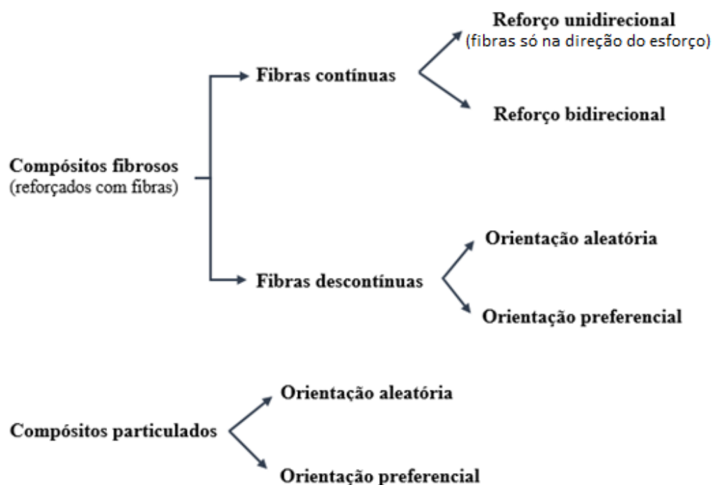
Figura 2.1. Diagrama de classificações dos materiais compósitos
