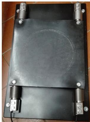
**Figura 2.16:** Dispositivo com quatro células de carga para permite medir o peso da botija.
