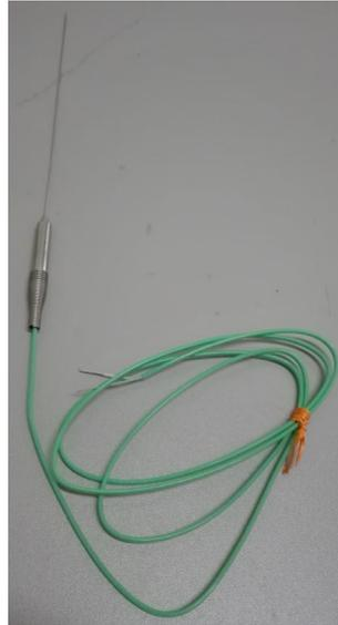
**Figura 2.11:** Termopar KMTXL-IM075U-150 do Tipo-K da *Omega*.
