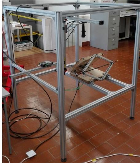
**Figura 2.8:** Estrutura de perfis onde todos os componentes dos ensaios serão instalados.
