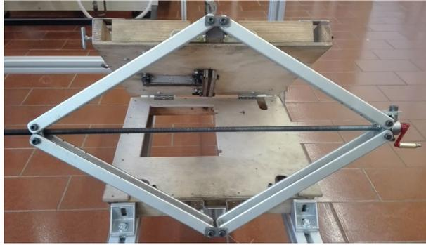
**Figura 2.6:** Vista frontal do sistema de elevação com fusos da base de suporte das placas.
