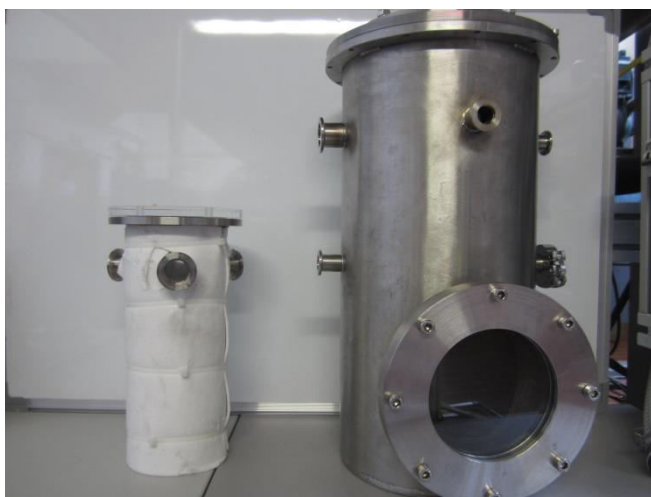
Figura 4.1 Câmaras de vaporização. Esquerda – câmara pequena; direita – câmara grande.
