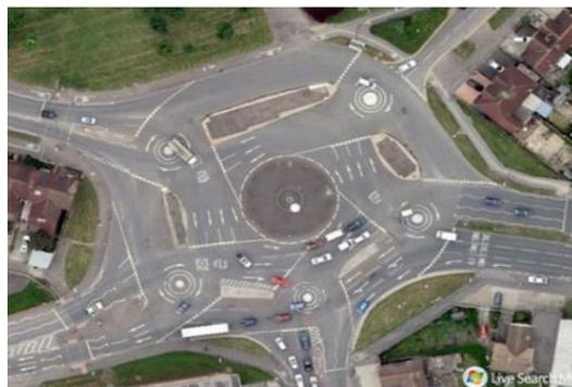
Figura 2.14 – Rotunda com disposição em anel (Google@ 2017).
