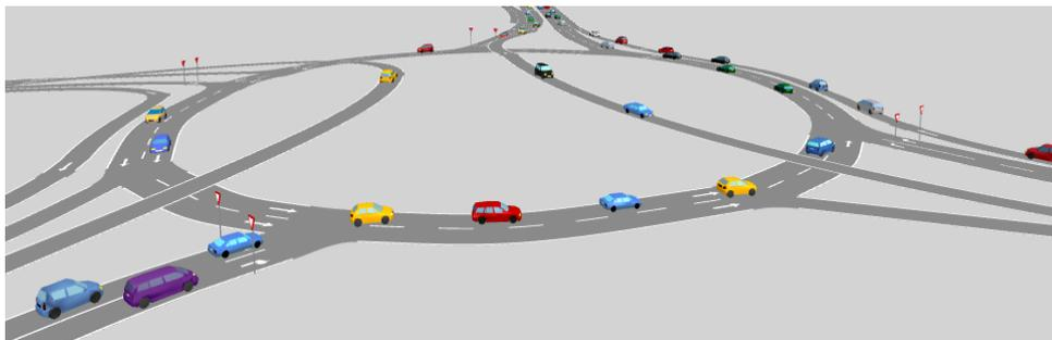
Figura 4.6 - Vista 3D da rotunda do tipo *four-flyover*.
