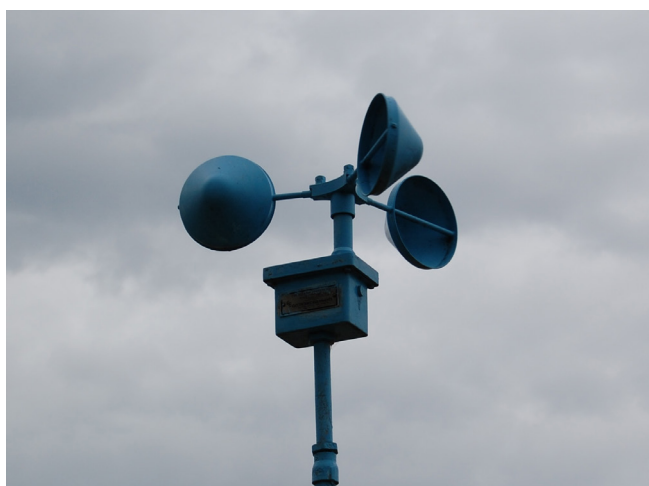
Figura 41 – esquerda Anemómetro de conchas hemisféricas
