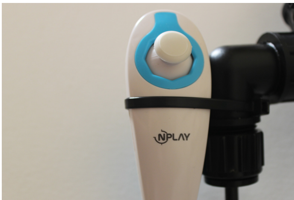
Figura 104 Fixação do Nunchuk com uma braçadeira de plástico
