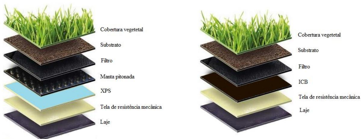
Figura 3.2 - Sistema de cobertura verde com XPS (esquerda) (adaptado de EM@, 2017); sistema de cobertura verde com ICB (direita) (adaptado de EM@, 2017).
