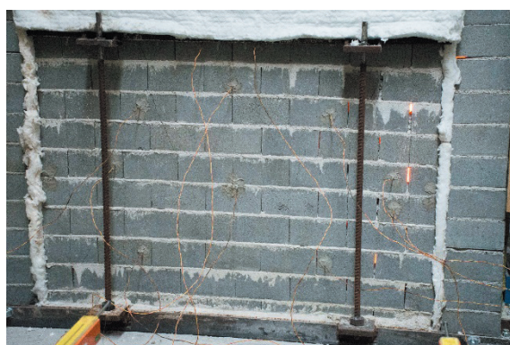
Figura 3.39 - Provete 6 - Sequência de colapso estrutural - 1 de 2
