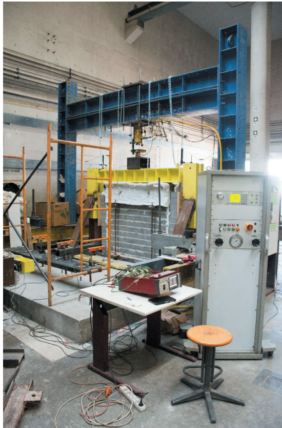
Figura 3.17 – Esquema experimental – Pormenor da central, do datalogger e pórtico de reação
