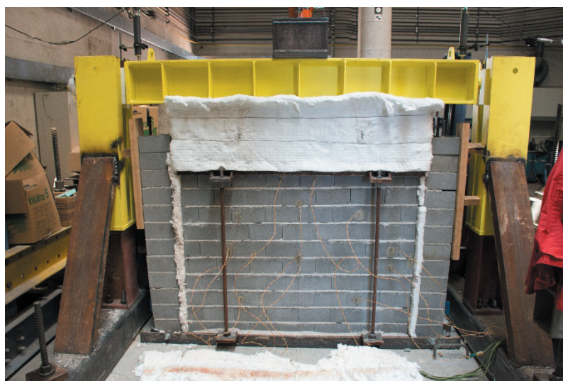
Figura 3.20 - Provede montado no sistema de ensaios
