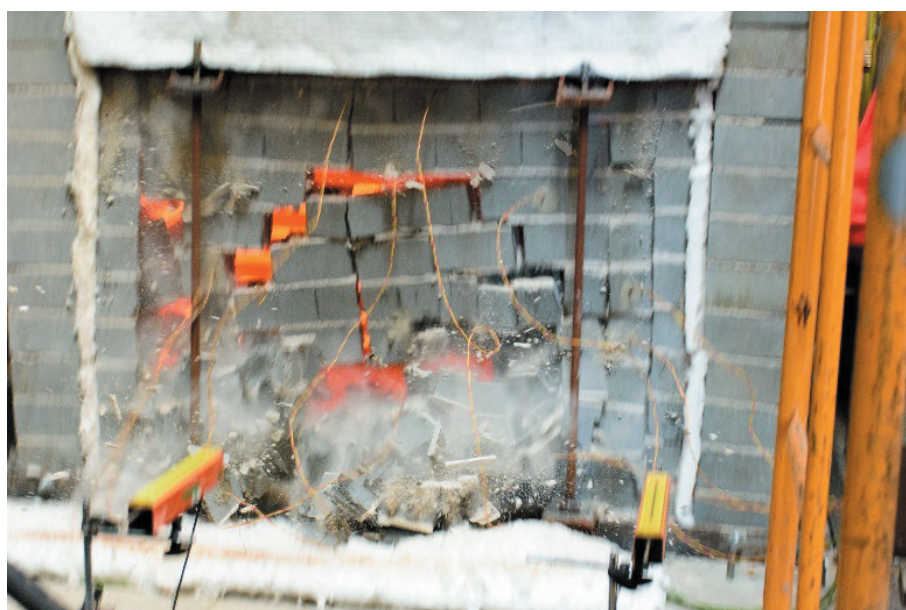
Figura 3.38 - Provete 4 – Colapso súbito
