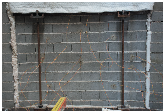
Figura 3.35 - Provetes 4 – Sinais de condensação nas fissuras verticais durante o ensaio
