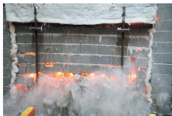
Figura 3.39 - Provete 6 - Sequência de colapso estrutural - 1 de 2
