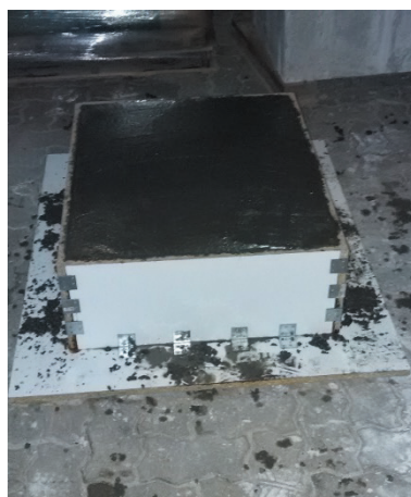
Figura 3.2 - Lajeta de betão após betonagem
