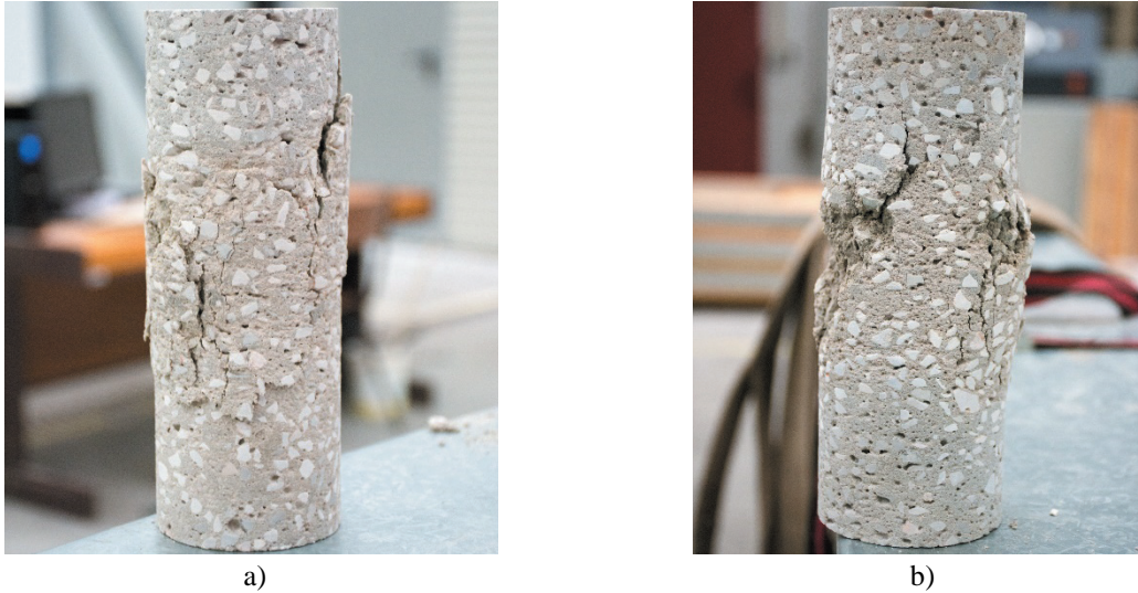
Figura 3.9 - Aspeto dos provetes de betão das unidades de alvenaria após ensaio: a) T = 500 °C; b) T = 700 °C
