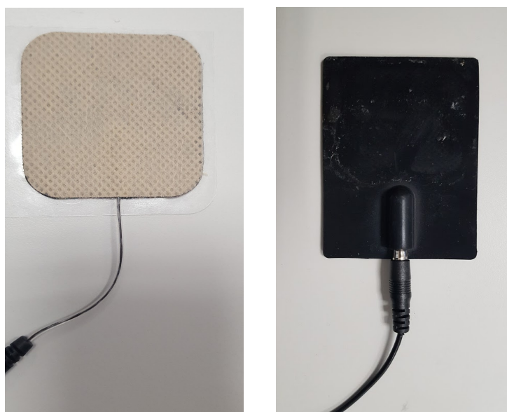
(a) Elétrodo ativo. Dimensões: 4 \times 4 \text{ cm} . (b) Elétrodo inativo. Dimensões: 8,4 \times 6,0 \text{ cm} .
