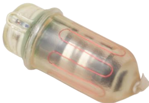
Figura 7 – Dispositivo Smart Pill capaz de medir temperatura, pressão e pH do aparelho digestivo dos pacientes (retirado de [27]).
