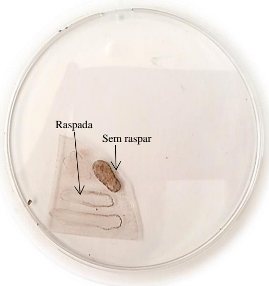
Figura 29 - Imagem da membrana de PDMS sem tratamento depois de aplicada a tinta metálica desenvolvida com o copolímero PDMS 68 - b -P4VP 40 (20 mg copolímero – 0,8 mL IPA) e com um elevado teor em partículas de cobre (100 mg).
