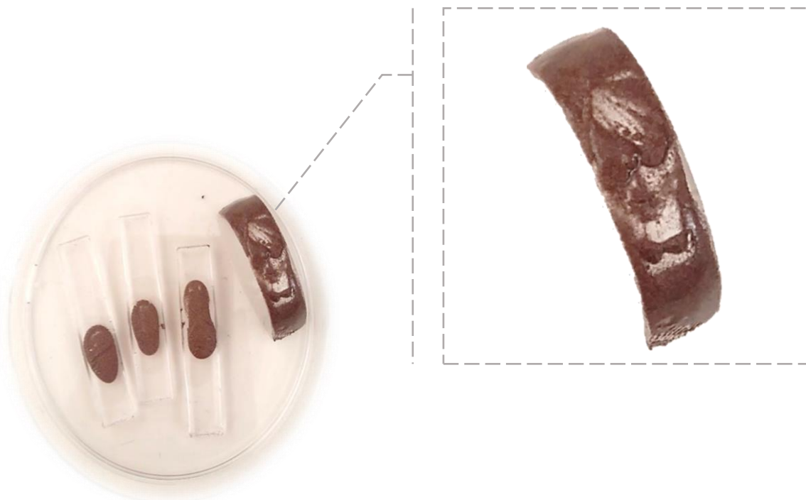
Figura 31 - Imagem do resultado da incorporação das partículas metálicas (100 mg) na presença do copolímero P4VP_{41}\text{-}b\text{-}PDMS_{17}\text{-}b\text{-}P4VP_{41} (10 mg copolímero – 0,25 mL IPA) e agente de reticulação (0,5 mg) na formulação da camada superficial do PDMS.
