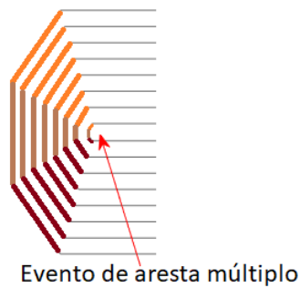
Fig. 2.5 Três eventos simultâneos de colapso de arestas adjacentes.
