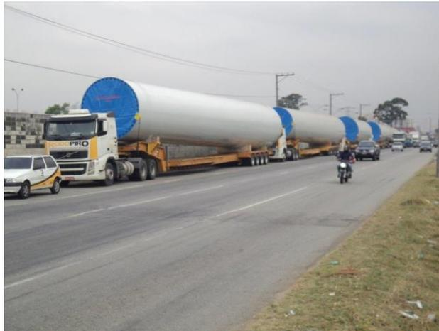
Figura 2.10– Transporte especial de componentes de torre eólica em aço (<http://www.transportepesado.com.br>).
