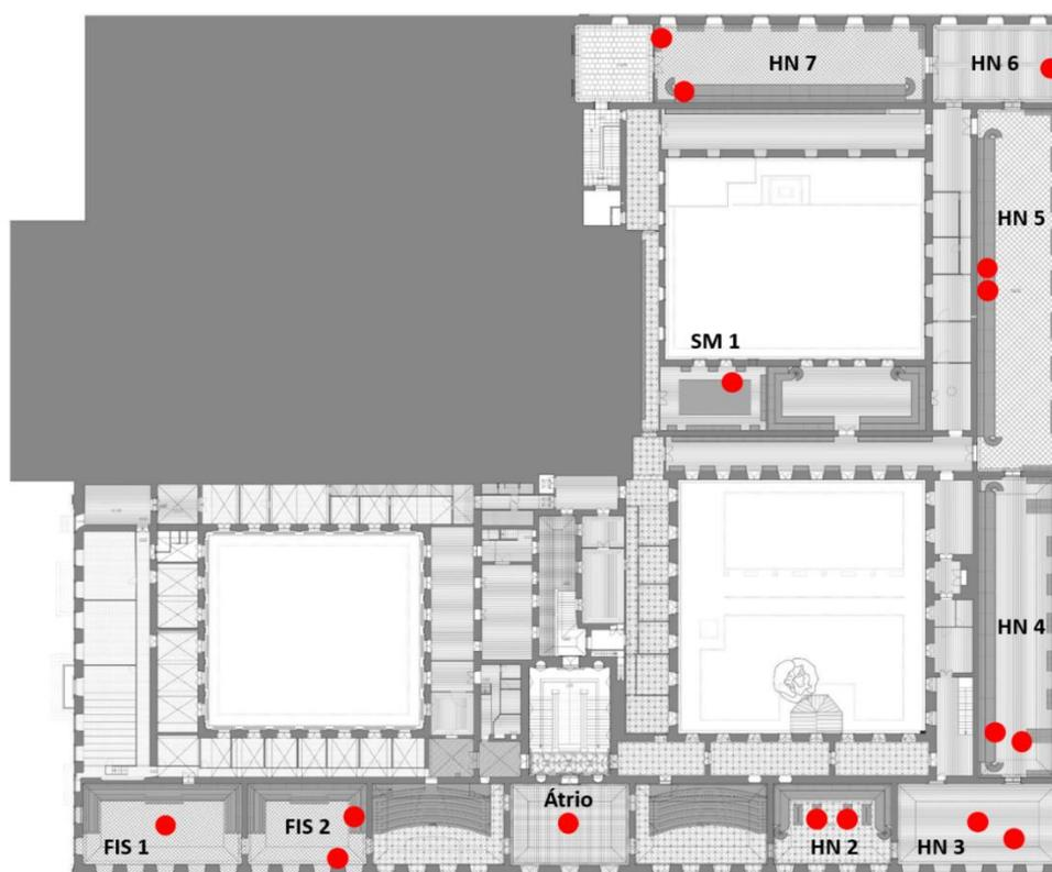
Figura 3.5 - Localização dos sensores no interior do MCUC
