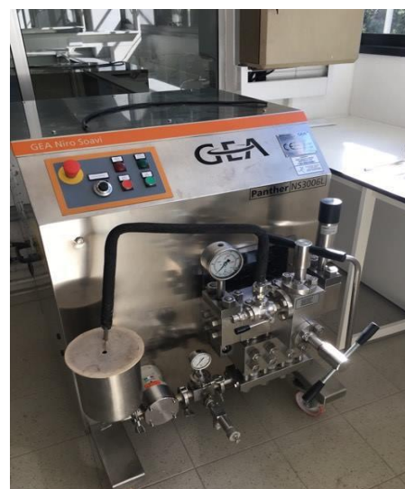
Figura 3.1 Equipamento utilizado no tratamento mecânico das CNF/CMF.
