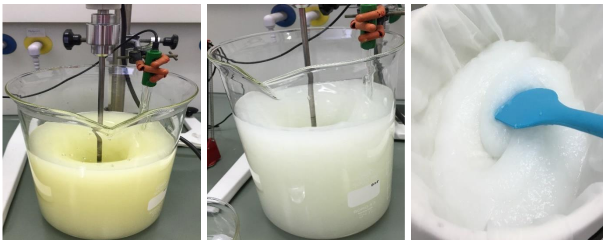
Figura II.1 Fases da reação de oxidação mediada por TEMPO (da esquerda para a direita, a primeira imagem corresponde a fase após a adição da solução de NaClO, a segunda corresponde ao fim da reação, onde o NaClO foi consumido. Já a ultima imagem corresponde às fibras oxidadas após a lavagem).
