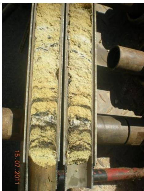
Figura 3.3 amostrador aberto após o ensaio - (Gsg@, 2011)
