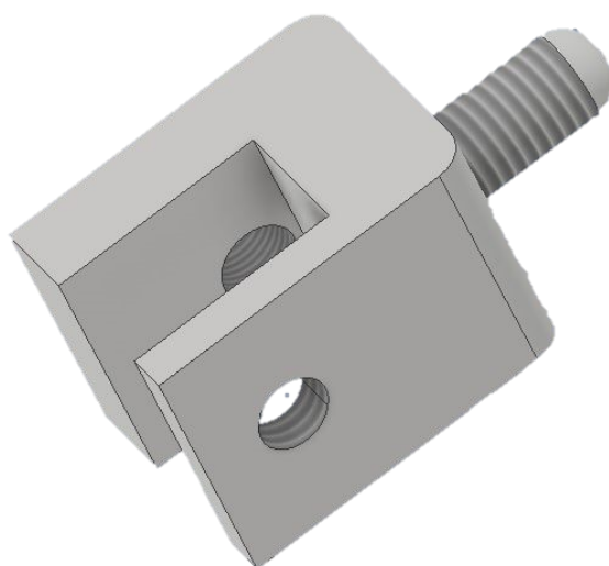
Figura 4.10: Modelo 3D das garras utilizadas feito a partir do software Inventor ®
