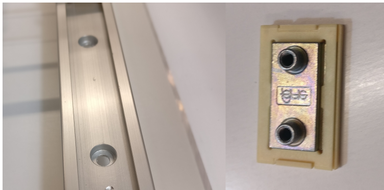
Figura 4.14: Pequena secção da calha deslizante à esquerda e mesa auto lubrificada à direita
