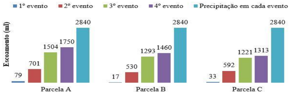
Figura 4.3 – Escoamento e precipitação total para as três parcelas e para os quatro eventos de precipitação.
