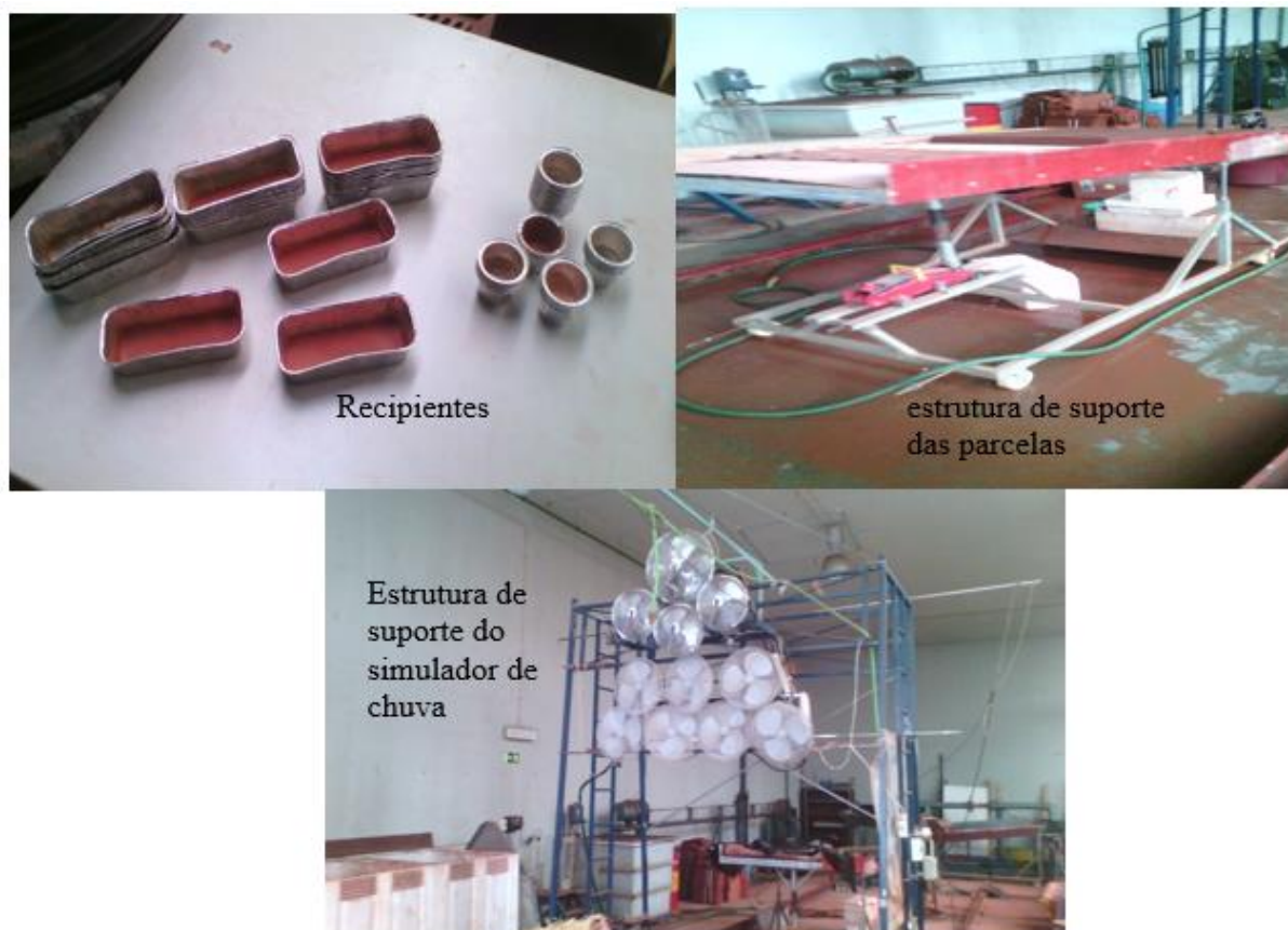
Figura A.1 – Recipientes e equipamentos utilizados na realização das experiências laboratoriais.
