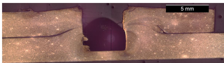
Figura 4.6. Macrografia do perfil de soldadura do provete S870B-1, realizado com recurso à ferramenta B com pino de 5 mm e velocidade de rotação de 870 rpm.
