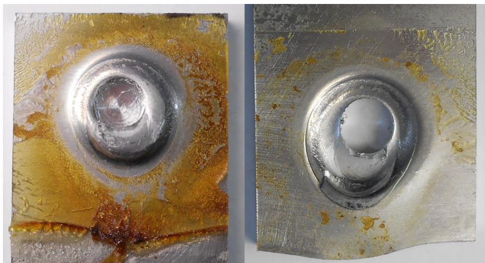
Figura 4.40. Superfície de rotura do provete H870B-4 relativo à série híbrida
