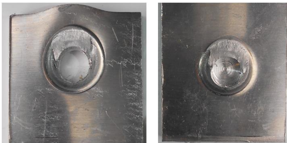
Figura 4.39. Superfície de rotura do provete C500-2 relativo à série soldada
