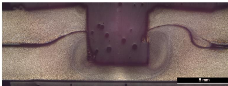
Figura 4.9. Macrografia do perfil de soldadura do provete H870B-1, realizado com recurso à ferramenta B com pino de 5 mm e velocidade de rotação de 870 rpm
