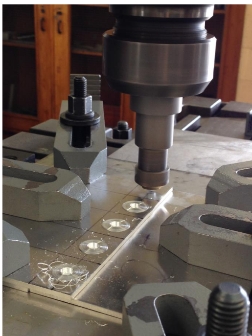
Figura 3.3. Realização da soldadura das placas de AA2017 com as dimensões 150x100x3 [mm].
