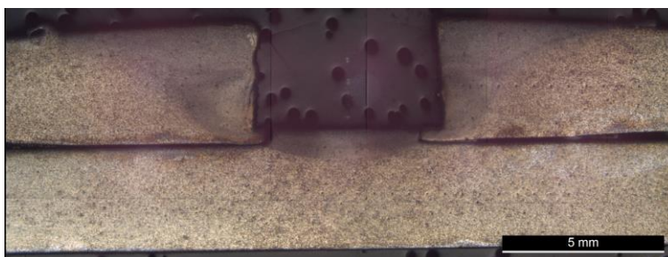
Figura 4.10. Macrografia do perfil de soldadura do provete H870A-1, realizado com recurso à ferramenta A com pino de 3 mm e velocidade de rotação de 870 rpm
