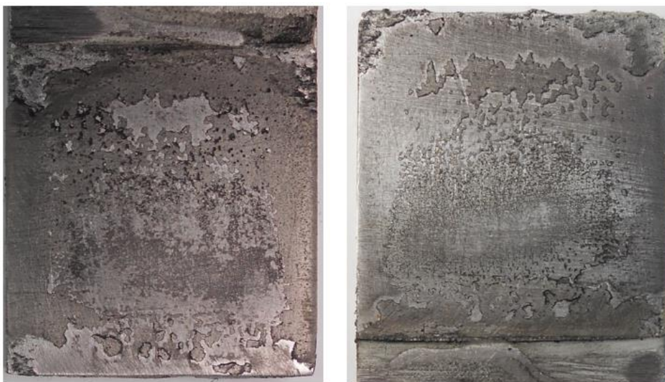
Figura 4.38. Superfície de rotura do provete C-2 relativo à série colada
