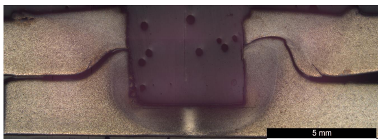
Figura 4.8. Macrografia do perfil de soldadura do provete H500B-3, realizado com recurso à ferramenta B com pino de 5 mm e velocidade de rotação de 500 rpm
