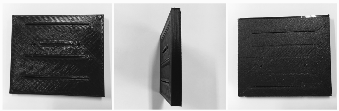
Figura 4.31: Modelo final da segunda guia de corte, com a qual se efetuam os restantes cortes femorais: côndilos e chanfros anteriores e posteriores.
