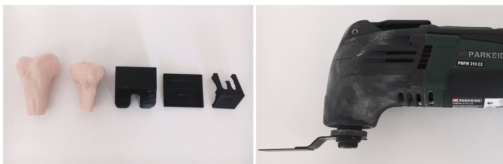
Figura 4.34: Representação de todos os modelos finais impressos, à esquerda , e da máquina que se utilizou para realizar os cortes, à direita .
