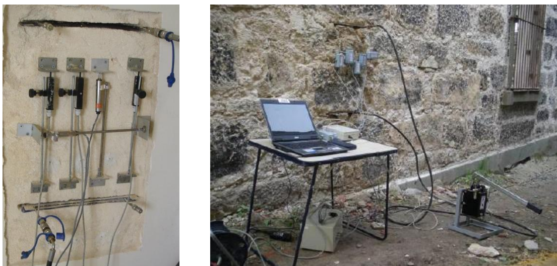
Figura 4.3 – Realização do ensaio de macacos planos duplo (Ferreira, 2010, à esquerda, e Miranda, 2011, à direita)
