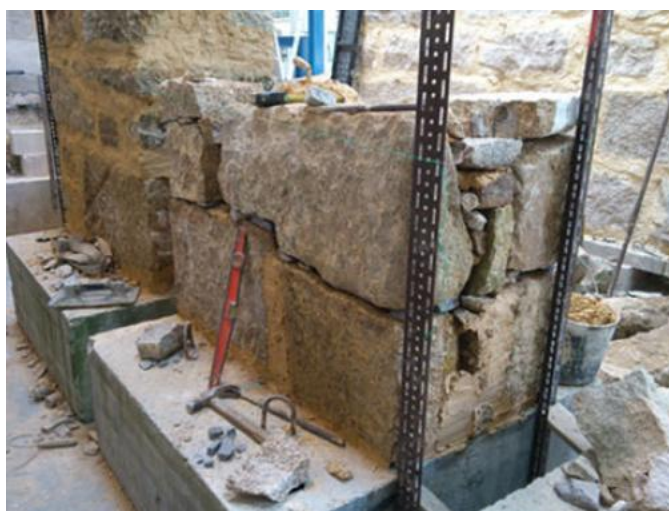
Figura 5.2 – Construção de paredes de alvenaria em laboratório para ensaio experimental (Ferreira, 2015)
