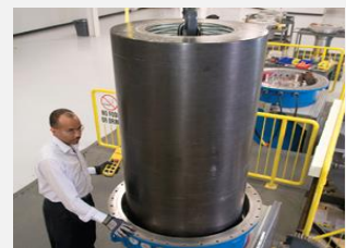
Volante de inércia, 200 unid. fornecem 20 MW /5 MWh
