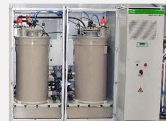
Uma unidade de células de fluxo, composta por 2 soluções em 2 reservatórios
