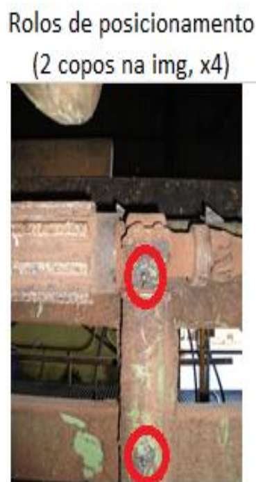
Figura 5.2. Exemplo de imagem de identificação dos copos da máquina.
