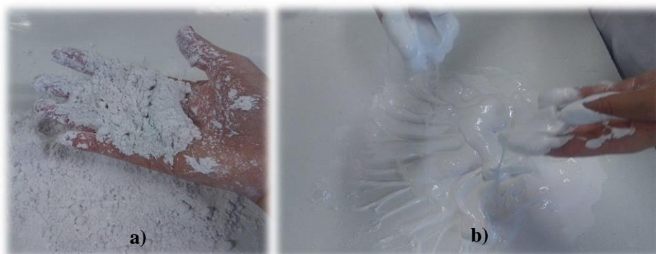
Figura 41 - a) Exemplo de uma formulação onde os diversos constituintes não ligaram, ficando granulada; b) Formulação que ficou muito fluida
