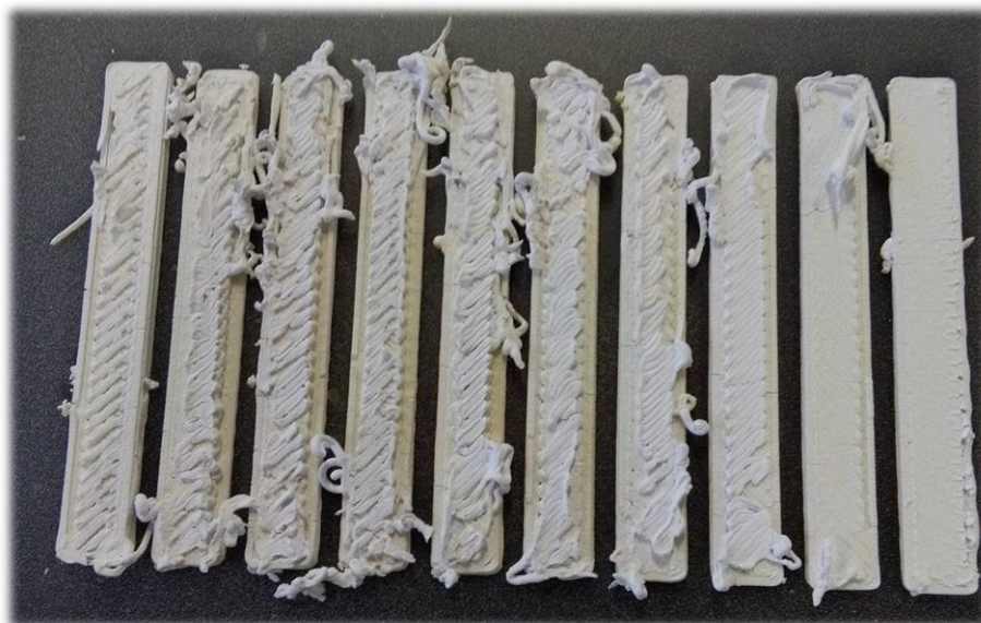
Figura 49 - Provetes impressos na impressora 3D com a pasta AI1_45_ZZ_G
