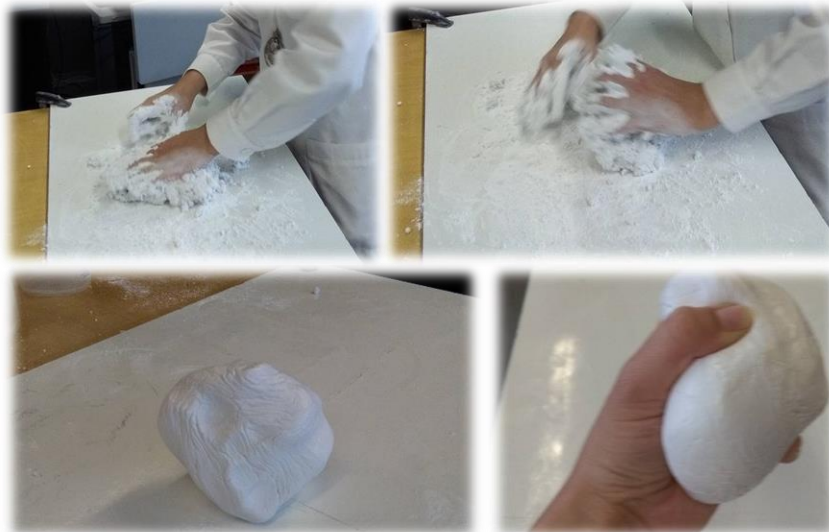
Figura 30 - Processo manual de preparação das pastas de alumina
