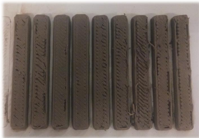
Figura 52 - Provetes obtidos com o 2º tipo de pastas (A11_PVA_A12), após debiding
