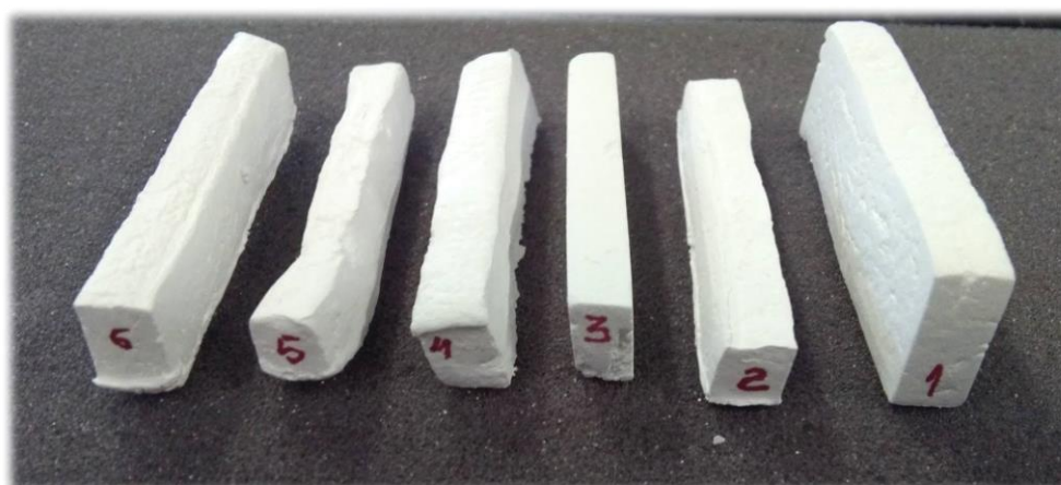
Figura 51 - Alguns dos provetes construídos com um molde antes da retificação com lixa
