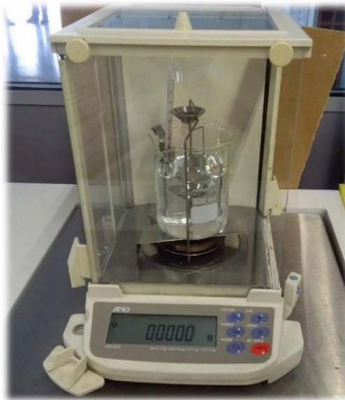
Figura 37 - Balança do CTCV para a determinação da massa volúmica pelo princípio de Arquimedes
