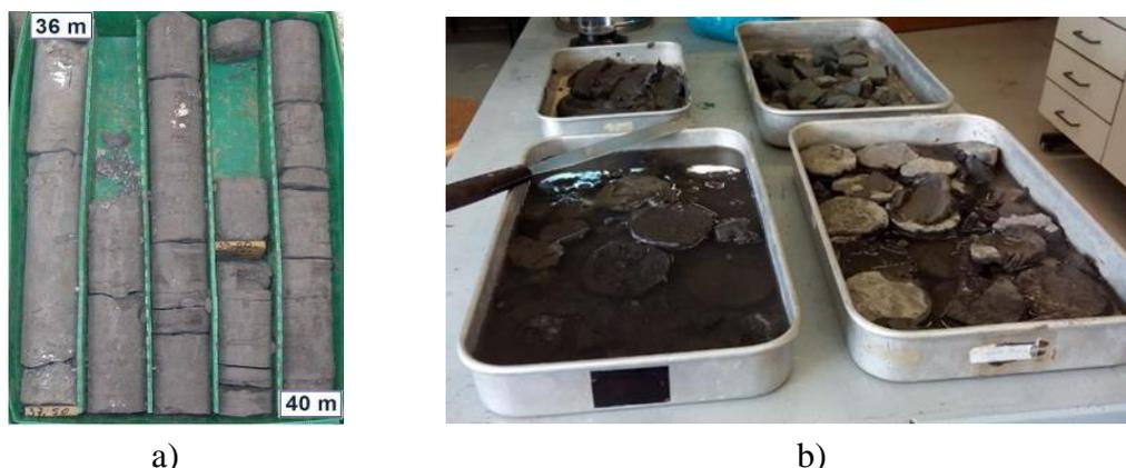
Figura 4.1 – a) Caixa de sondagem com as amostras recolhidas através dos furos de sondagem realizados no quintal do Edifício Quintão na Rua Ivens em Lisboa; b) desagregação do solo através da adição de água para as 4 profundidades
