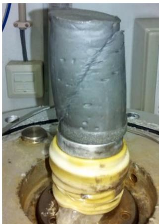
Figura 4.5 – Aspetto final da amostra após a fase de corte
