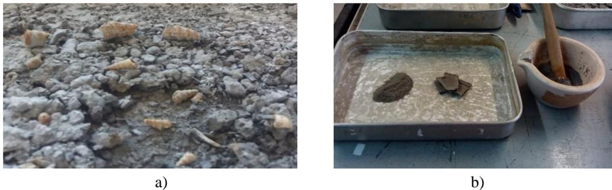
Figura 4.2 – a) Visualização de conchas para a profundidade de 37,0m; b) Diferenças entre um solo seco e um solo que foi reconstituído através do pilão e almofariz
