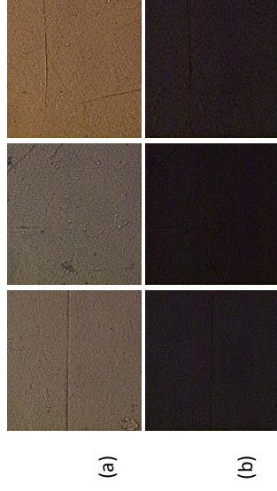
Figura E.71 – Imagens obtidas através da técnica PLM, a 200x, para as amostras (da esquerda para a direita) E21_s2, E22_s2 e E23_s2, com o saco de plástico na direção vertical: (a) sem o polarizador e analisador cruzados; (b) com o polarizador e o analisador cruzados.
