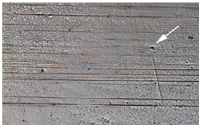
Figura 1.10 – Marcas de estrias num filme de plástico. A seta identifica a presença de uma inclusão de impureza na matriz polimérica do filme. Retirado de [1].
