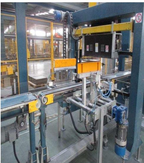
*Figura 21 - Máquina de Cintar*
