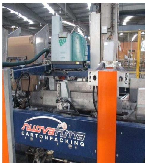
Figura 18 - Máquina de embalar (CPK)
