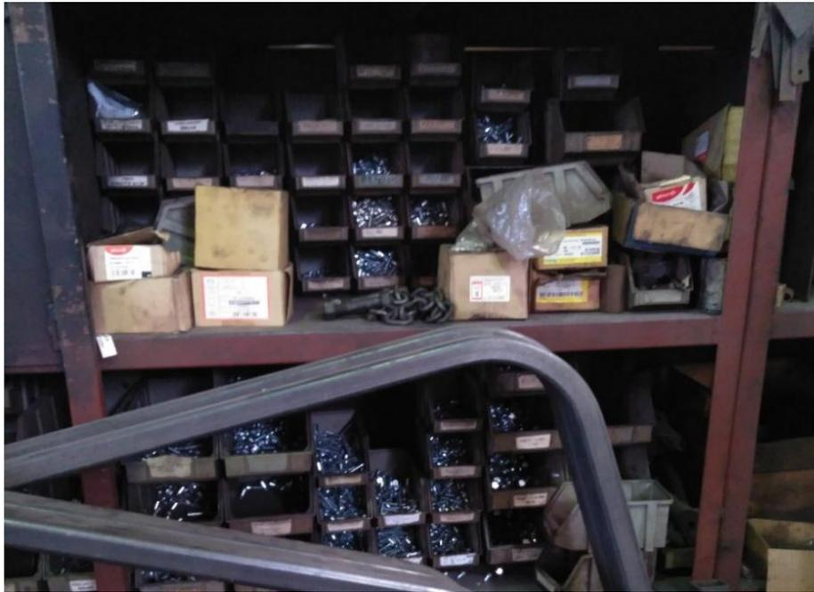
**Figura 5.3.** Exemplo de supermercado com caixas de *stock* normalizadas.
