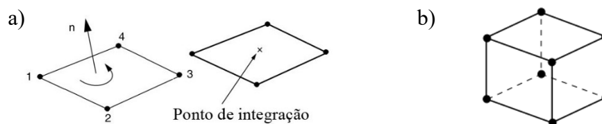
Figura 4.7 – Representação esquemática dos elementos finitos utilizados a) S4R; b) C3D8R Adaptado de (Systèmes, 2014)
