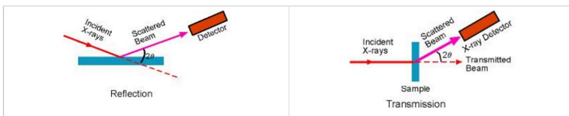
Figura 3.9 Do lado esquerdo: ao interagir com o material o feixe de raios-X é refletido, sendo que o ângulo de incidência do feixe é igual ao ângulo do feixe refletido relativamente ao plano da superfície da amostra. Do lado direito: O feixe incide perpendicularmente à superfície da amostra sendo que este é dispersado com um dado ângulo. Em ambos os métodos os ângulos de dispersão estão relacionados entre si. [Materials research Laboratory at UCSB: an NSF MRSEC].
