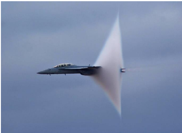
Figura 2.2 O cone de vapor formado pelo “sonic boom” de uma aeronave é o resultado do efeito da onda de choque sobre a água em estado gasoso presente no ar [Miramar air show].
