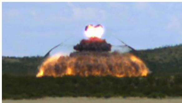
Figura 2.3 Uma explosão de dinamite mostra claramente o efeito da onda de choque no índice de refração do ar na superfície da frente de onda. Veja-se a aberração causada nos montes atrás da explosão. [BBC, Invisible Worlds].
