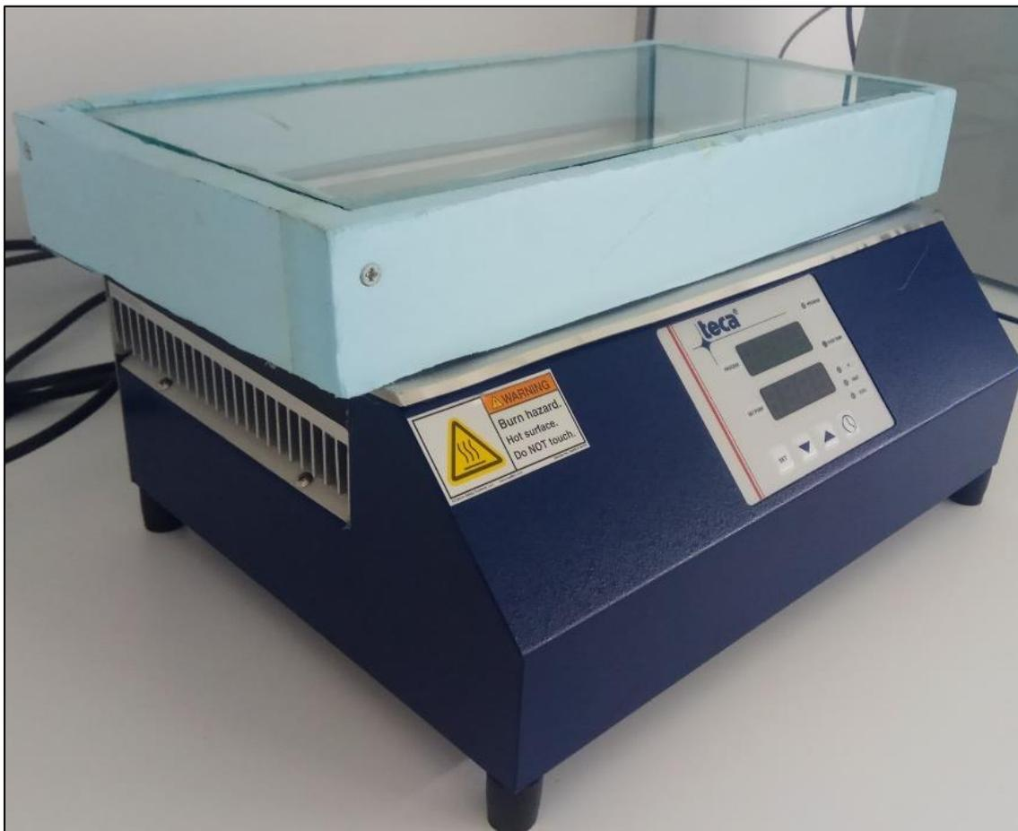
Figura 5.2 - Fotografia da placa termoeletrica TECA e correspondete caixa protetora
