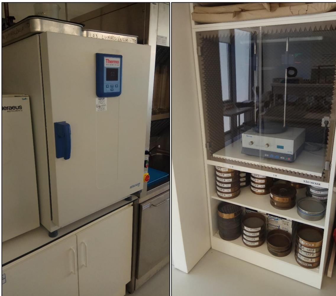
*Figura 5.7 - Equipamento do laboratório de sedimentologia utilizado: à esquerda - Forno; à direita - Agitador e respetivos crivos.*
