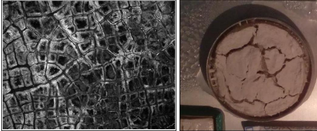
Figura 6.17 - Comparação de terreno poligonal natural (Antártida), à esquerda (Reis, 2012), com um artificial, à direita.
