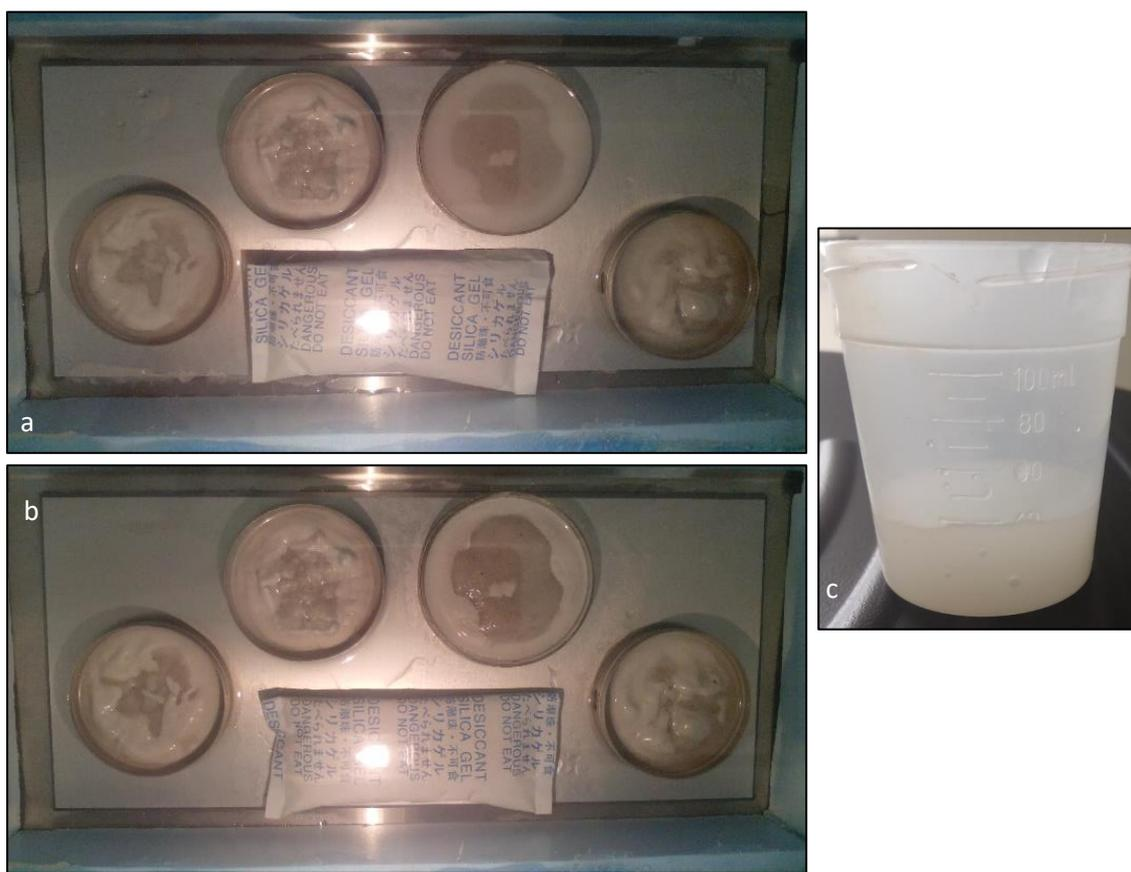
*Figura 5.5 - Demonstração da quantidade de água acumulada e posteriormente removida das amostras. (a) amostras antes de remoção da água em excesso (b) amostras após remoção da água em excesso (c) quantidade de água removida das amostras, 40 ml.*
