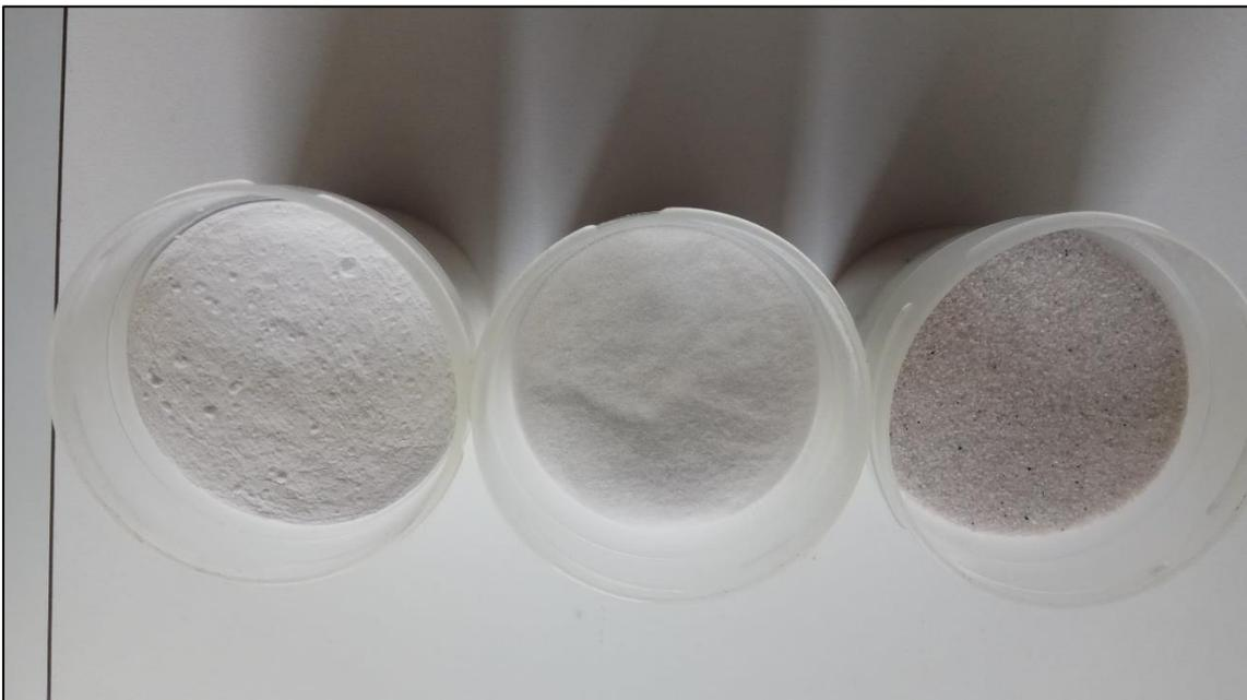
*Figura 5.6 - Sedimentos utilizados para as amostras. 100, 150 e 200  $\mu\text{m}$  respetivamente.*
