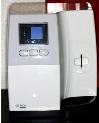
**Figura 4.** Aparelho de revelação automática das placas de fósforo fotoestimuláveis digitais.
