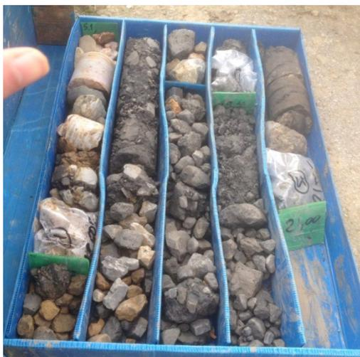
Figura 34 - Caixa com material de perfuração e SPT's.
