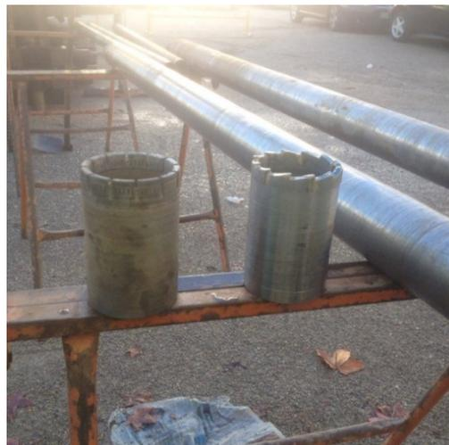
Figura 36 - Coroa diamantada (esquerda) e coroa de tungsténio (direita).
