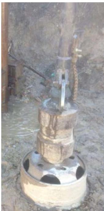
Figura 19 - Equipamento utilizado para realizar o ensaio SPT.
