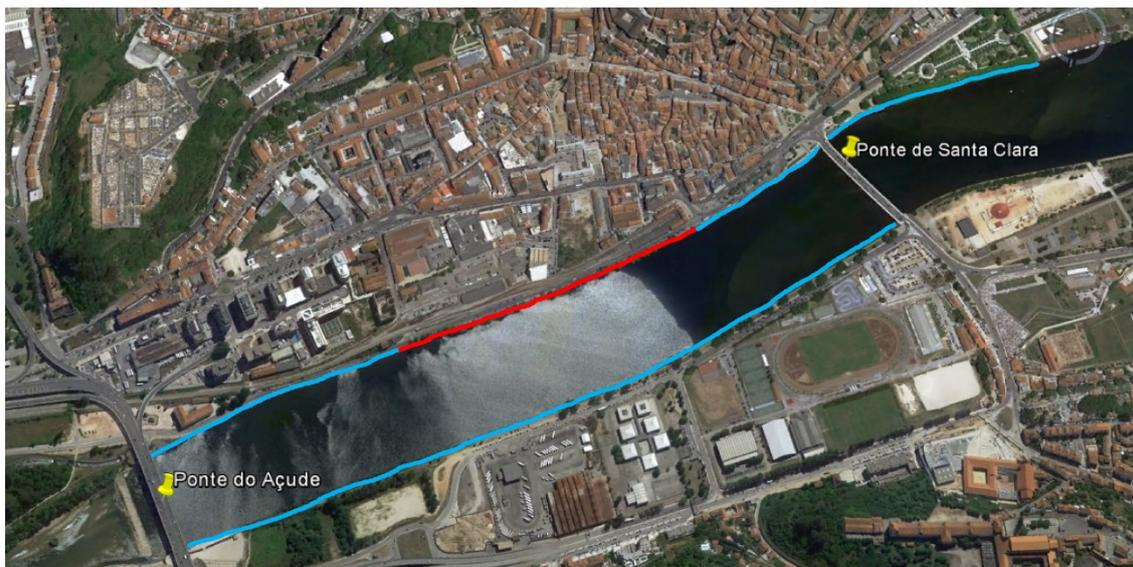
Figura 2 - Limites dos principais muros nas margens do Mondego. A linha vermelha representa os muros que serão alvo de requalificação prioritária (Google Earth, 2017).
