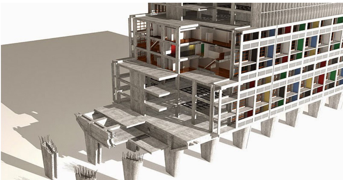
Fig. 58 _ Corte perspectivo do edifício, mostrando a forma de agregação dos apartamentos
