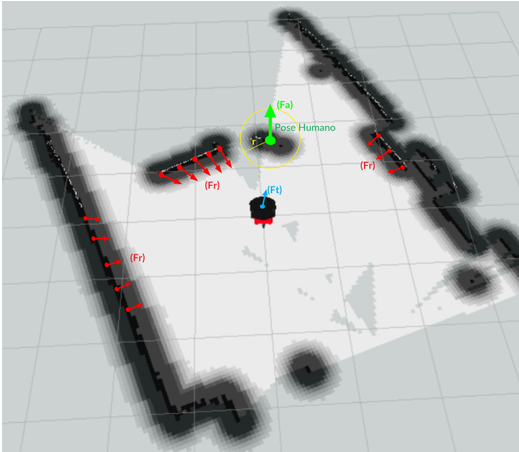
Figura 4.6: Representação vetorial da incidência dos dados de sensorização obtidos na navegação desenvolvida.
