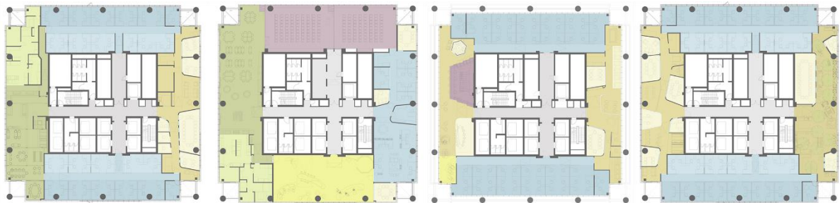
Figura 149 – Plantas dos pisos 27, 29, 31 e 33 do edifício ocupado pela Google em Tel Aviv. Azul – áreas de trabalho formal; Verde – áreas informais e de lazer; Roxo – auditórios.
