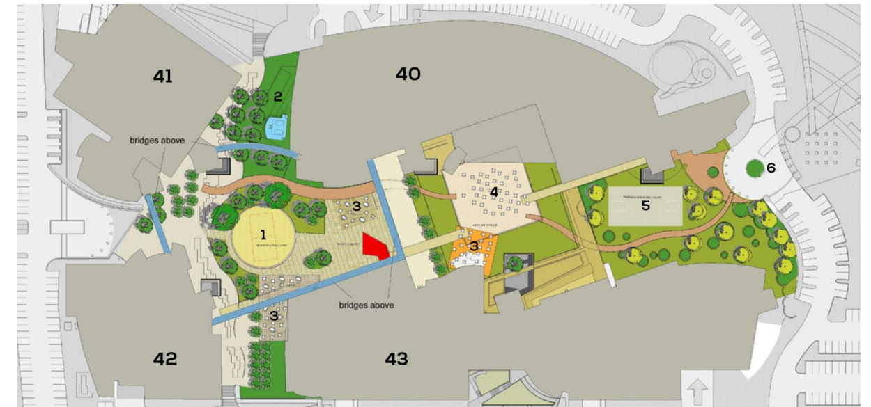
Figura 107 – Projeto de composição da rua principal que liga os edifícios 40, 41, 42 e 43: 1 – campo de voleibol exterior; 2 – piscinas; 3 – esplanadas; 4 – restaurante; 5 – campo de basquetebol (não construído); 6 – hortas. A azul as pontes que ligam os edifícios ao nível do segundo andar.
