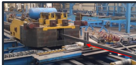
Figura 17 - Mordente a auxiliar a passagem da barra pela fieira da linha CD2.
