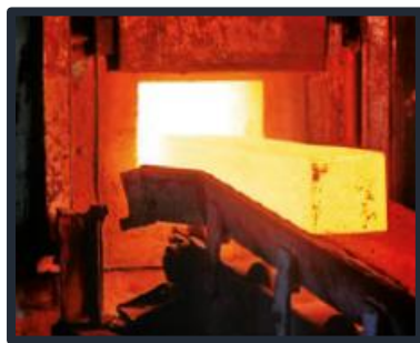
Figura 11 - Saída do forno de um lingote para trem aberto.
