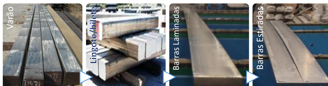
Figura 119 - Matéria-prima e produtos resultantes de cada etapa de produção de estirados.
