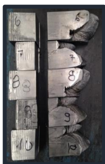
Figura 59 - Pontas de sucata de estirados do atado que continha a barra curta.
