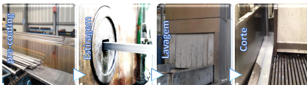
Figura 14 - Sequência de etapas referentes à estiragem.
