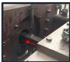
Figura 15 - Passagem da barra através da fieira da linha CD2.
