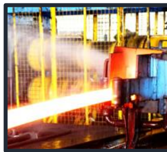
Figura 12 - Produção de barras por laminagem a quente.
