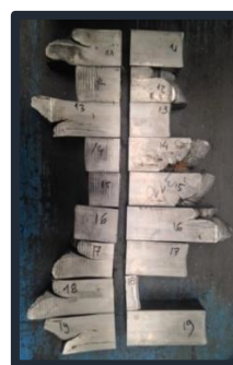
Figura 60 - Pontas de sucata de estirados do atado 3051768.01, que continha a barra comprida.
