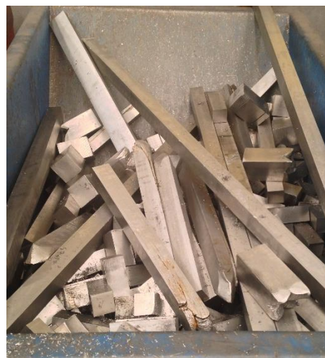
Figura 1 - Sucata de estirados de grade 1.4307 da linha de estiragem CD2.
