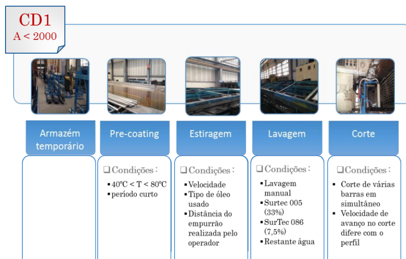
Figura 79 - Sequência e condições de operação da linha de estiragem CD1, usada para perfis com uma secção reta menor do de 2000 mm 2 .
