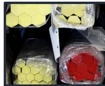
Figura 45 - Exemplos de perfis hexagonais produzidos na linha CD2.
