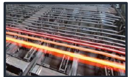
Figura 13 - Barras laminadas incandescentes na estenderia.
