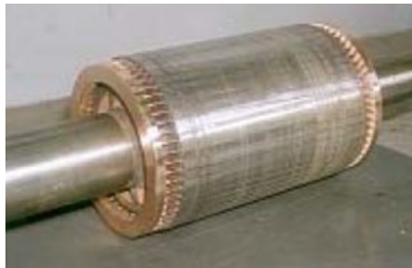
Figura 2.2: Exemplo de rotor em gaiola de esquilo.
