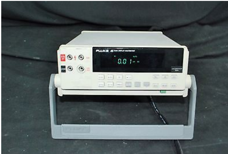
Figura D.2: Multímetro digital Fluke 45 para a medição das resistências estáticas dos motores.
