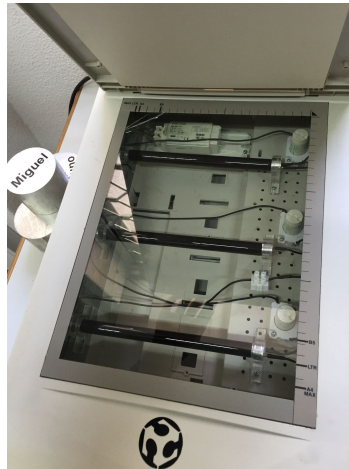
Figura 2.19 Imagem da insuladora utilizada
