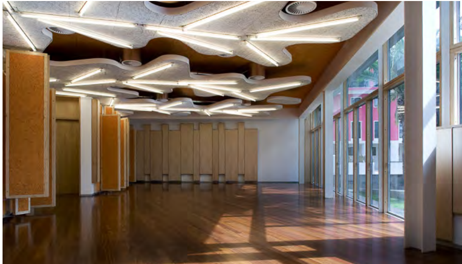
63 | Sala Polivalente, onde é possível ver as paredes tratadas acústicamente, do lado esquerdo, Conservatório de Música de Cascais
