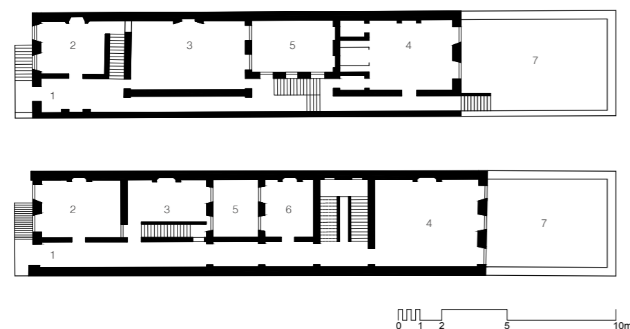
57. Plantas de dois pisos térreos da habitação tipo de Amesterdão no séc. XVII situadas no Bairro Jordaan 1. Entrada 2.Sala 3.Sala de Refeições 4. Cozinha 5. Pátio Interior 6. Quarto 7. Pátio Exterior
