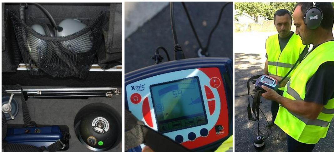
Figura 36 - Detecção por sondagem acústica com recurso a geofone (AdNorte, 2017)
