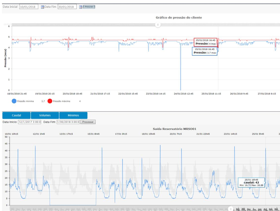
**Figura 33 – Gráfico de pressões referente à monitorização da pressão (AdNorte, 2017)**
