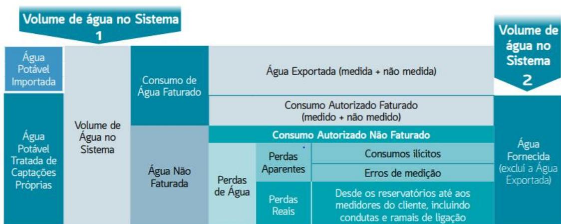
Figura 1 - Balanço Hídrico de acordo com a definição da IWA (EPAL, 2017)
