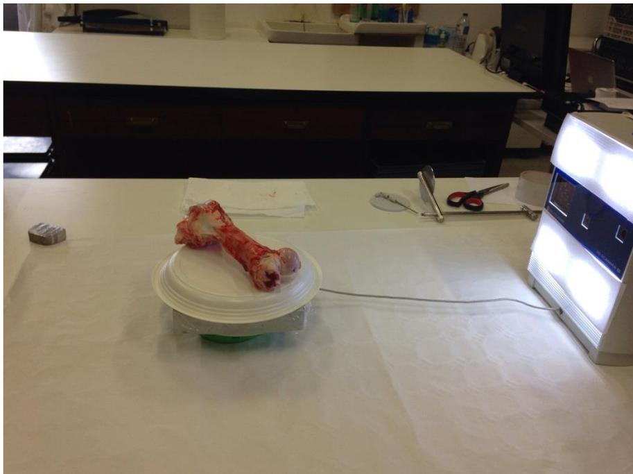
**Figura 5** – Foram coladas ao scanner folhas de papel branco para ofuscar a luz da câmara do flash, que deixava algumas zonas “vazias” e extremamente brancas no modelo 3D.
