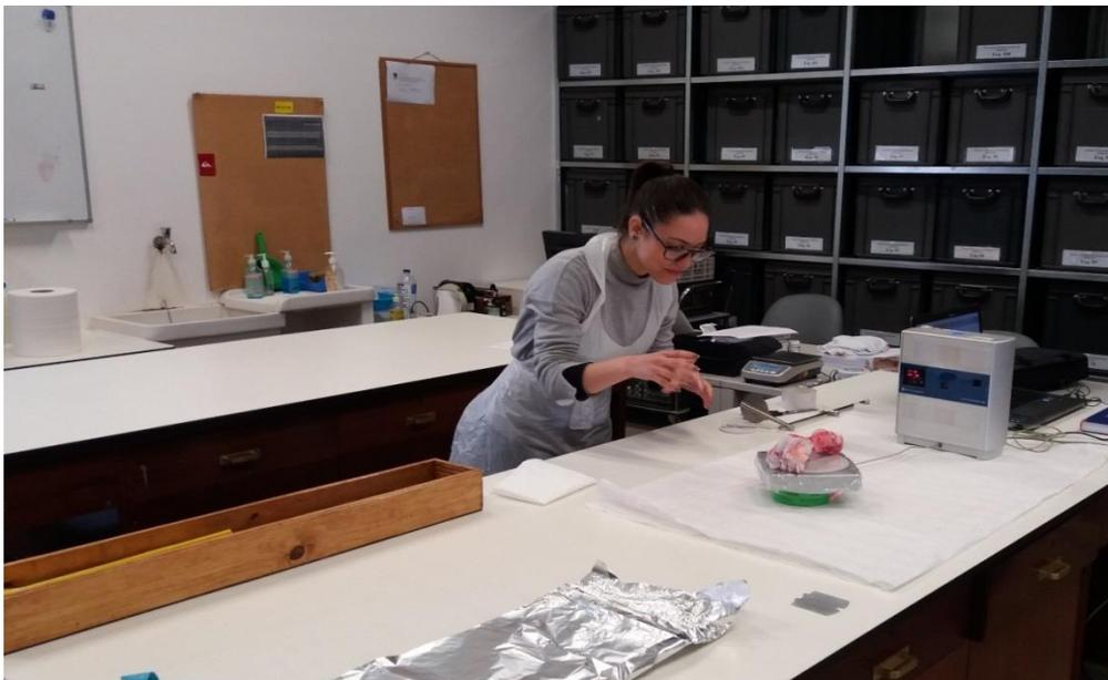
**Figura 3** – Peça anatómica colocada horizontalmente no Scanner 3D, NextEngine.
