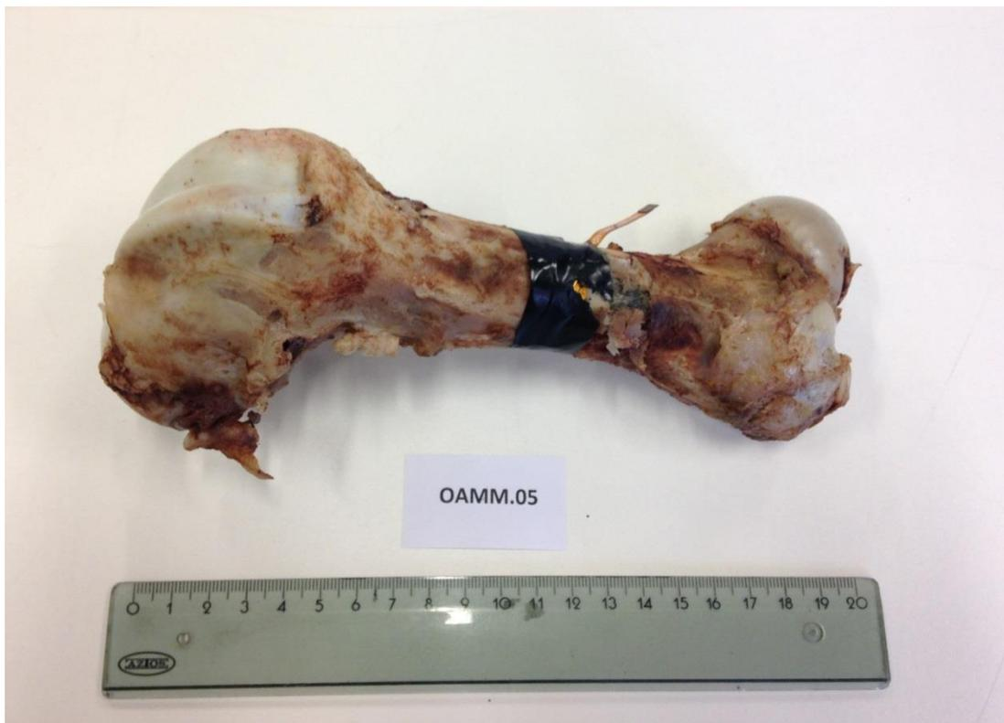
**Figura 37** – OAMM N° 5 cozido, que não partiu, presença de sensor.
