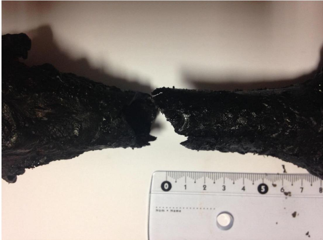
**Figura 24** – OAMM N° 8 com fractura em borboleta.
