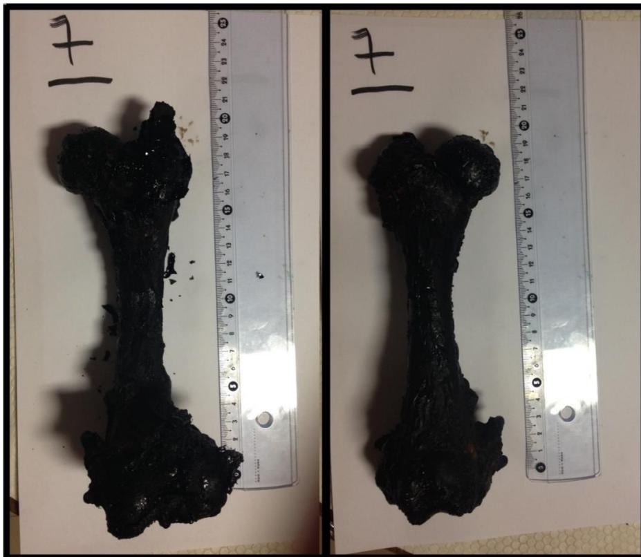
**Figura 21** – OAMM N° 7 após assar em forno doméstico.
