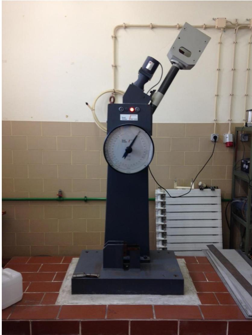
**Figura 1** – Pêndulo do Departamento de Engenharia Mecânica da Universidade de Coimbra.
