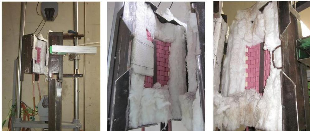
Figura 4.2 – a) Forno aberto; b) parte esquerda, móvel; c) parte direita fixa
