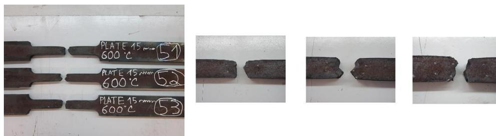
Figura 4.11 – Modo de rotura dos provetes de Chapa 15 mm a 600 °C
