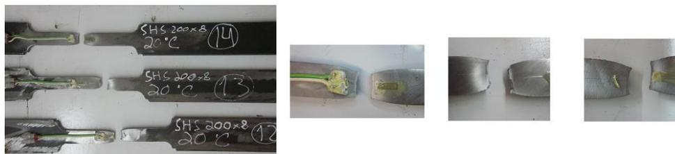
Figura 4.9 – Modo de rotura dos provetes de tubos de 8 mm à temperatura ambiente
