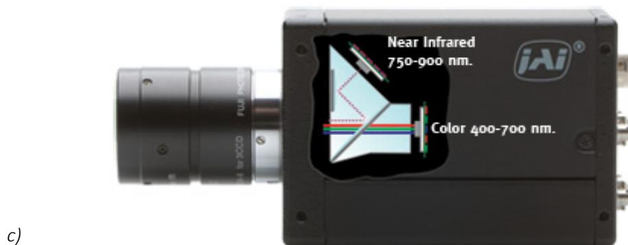
Fig. 2.2. Sistemas de visão multispectrais: a) “Espelho” transmissão/reflexão [21]; b) Roda de filtro [17] c) Câmera JAI com dois sensores RGB+Nir [36].
