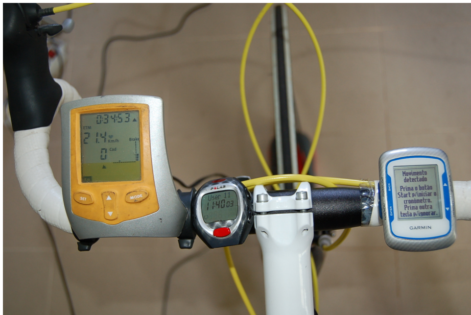
Figura 5 - Dispositivo de controlo dos patamares de intensidade dos rolos (à esquerda)
