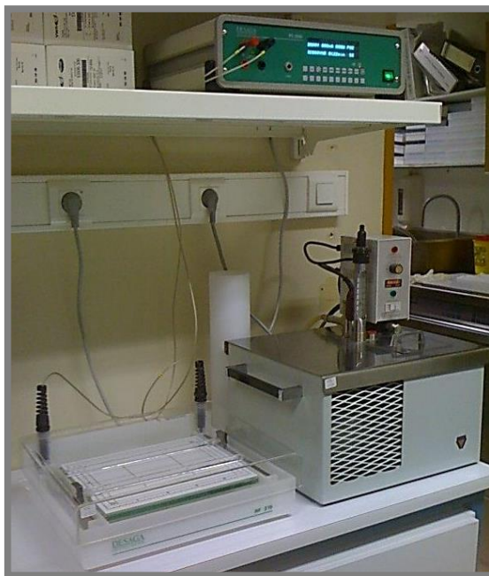
Figura 2.1 ó Equipamento de focagem isoeletrica: tina para focagem, banho de arrefecimento termostaticado e fonte de alimentaçã. Laboratório de Neuroquímica do CHUC ( DESAGA Sarstedt-gruppe HF210, PS 3000, Alemanha ).
