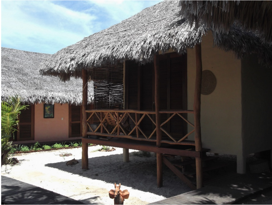
Fotografia 8 - Telhado de colmo para respiração e arrefecimento em Pousada no Estado do Piauí, Brasil.
