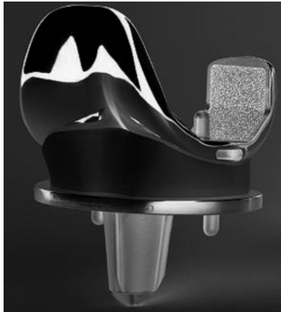
Figura 1.4. Prótesis de rodilla de acero inoxidable con plato tibial de polietileno de ultra alto peso molecular. El desarrollo del par metal-polímero se ha realizado para disminuir la fricción y el desgaste a lo largo de su vida útil.
