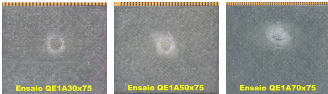
Figura A2.15 Imagem do dano na face anterior das placas de material quasi-isotrópico resultante do ensaio quasi-estático (Conjunto 2)
