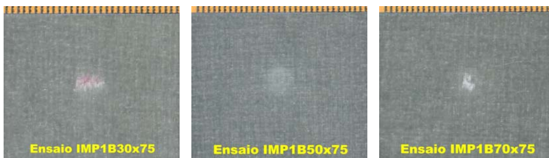
Figura A2.22 Imagem do dano na face posterior das placas de material cruzado anti-simétrico resultante do ensaio de impacto (Conjunto 2)
