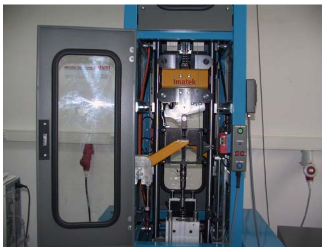
Figura 5.3 Máquina de ensaio de impacto IMATEK-IM10, existente no Laboratório de Ensaio de Materiais da ESTA- Instituto Politécnico de Tomar.
