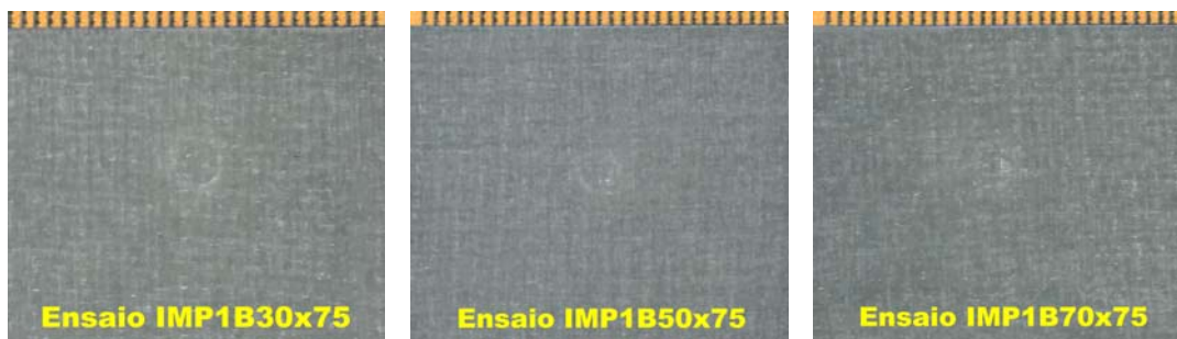
Figura A2.21 Imagem do dano na face anterior das placas de material cruzado anti-simétrico resultante do ensaio de impacto (Conjunto 2)
