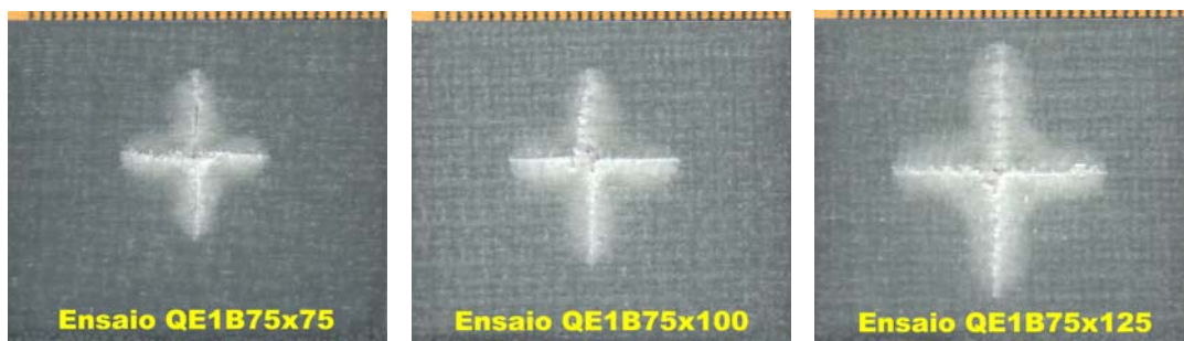
Figura A3.18 Imagem do dano na face posterior das placas de material cruzado anti-simétrico resultante do ensaio quasi-estático (Conjunto 3)
