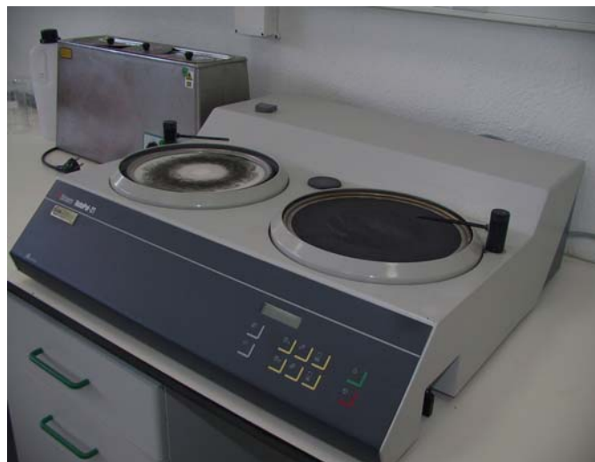
Figura 5.15 Polidora de amostras Struers Rotopol-21, existente no Laboratório de Ensaio de Materiais da ESTA- Instituto Politécnico de Tomar
