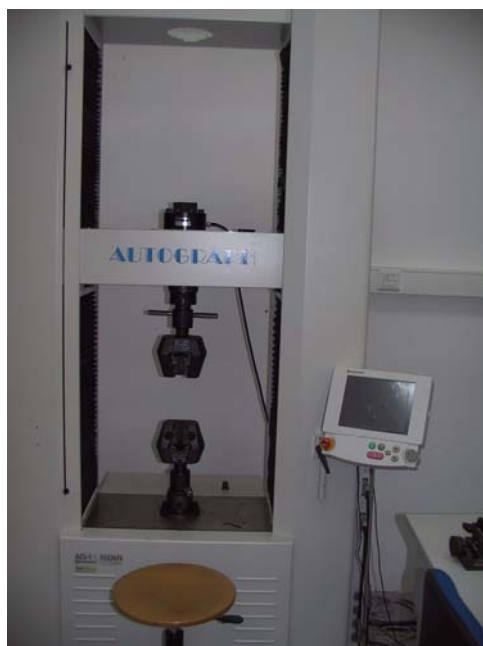
Figura 5.1 Máquina de ensaio de tracção SHIMATSU - AG-1, existente no Laboratório de Ensaio de Materiais da ESTA- Instituto Politécnico de Tomar.
