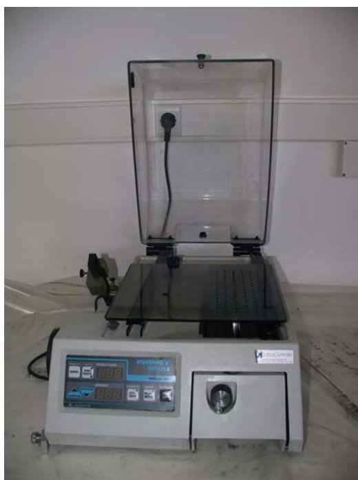
Figura 5.13 Serra de corte ISOMET-1000, existente no Laboratório de Ensaio de Materiais da ESTA- Instituto Politécnico de Tomar
