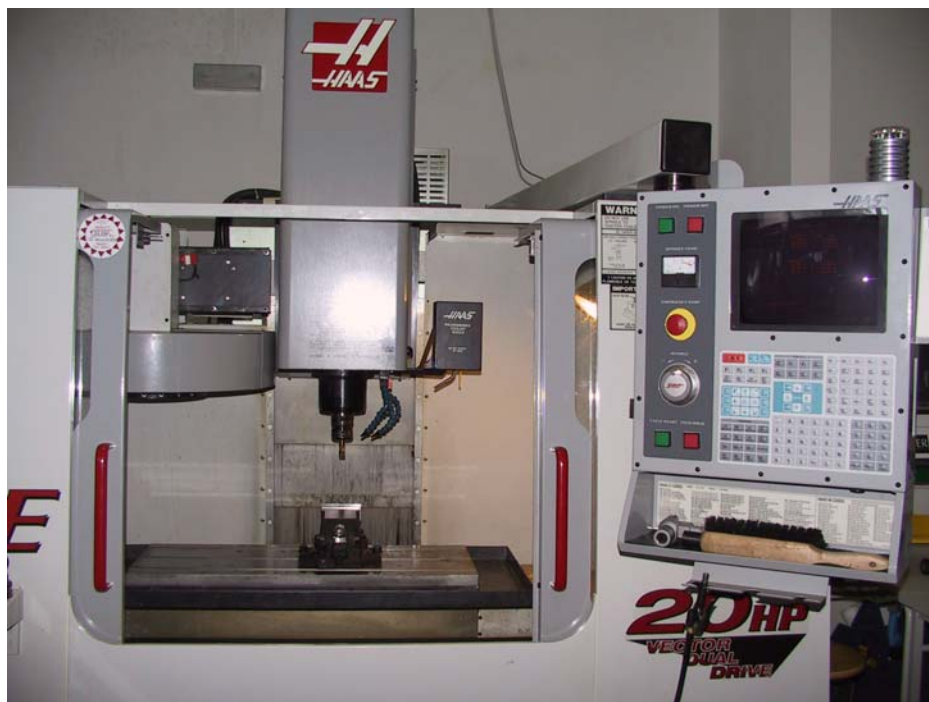
Figura 5.17 Centro de maquinagem CNC HAAS série VFE, existente no Laboratório de Fabricação Mecânica da ESTA- Instituto Politécnico de Tomar.
