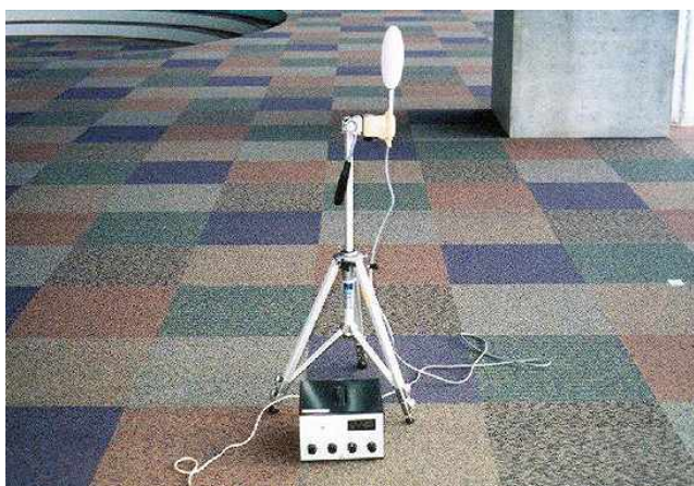
Figura 4.6 Medidor de conforto térmico
