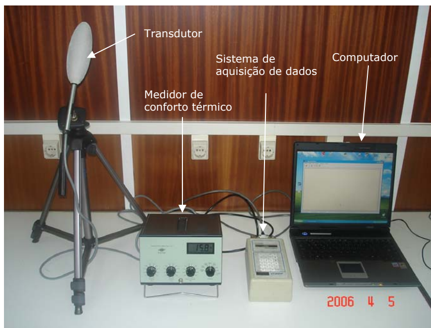
Figura 5.18 Esquema global da instrumentação utilizada relativa ao ambiente térmico
