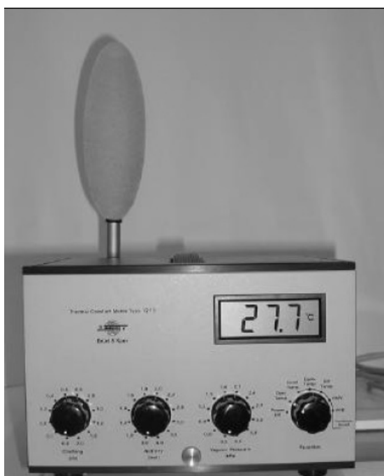
Figura 5.16 Medidor de conforto Brüel & Kjær 1212
