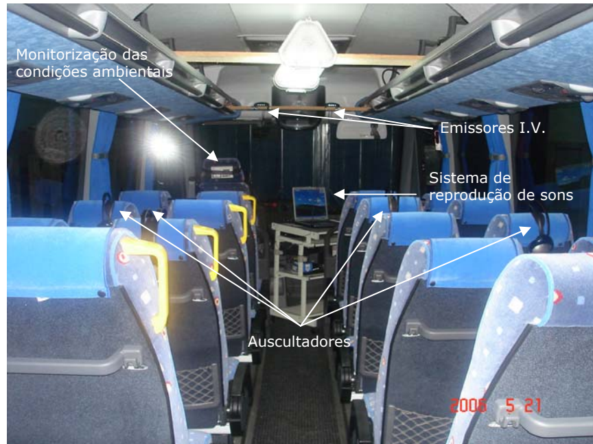
Figura 5.12 Vista interior do ambiente de reprodução dos sons
