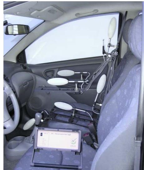
Figura 4.10 Distribuição dos sensores de conforto térmico em veículos (adaptado de Olesen, 1987)
