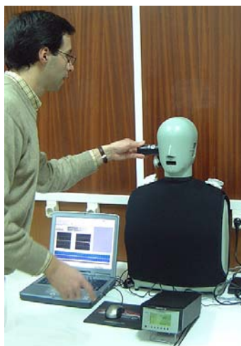
Figura 5.4 Procedimento de calibração do sistema de gravação sonora
