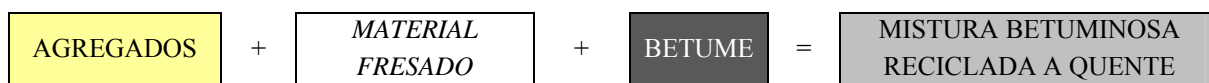
Figura 2.15 – Esquema dos materiais constituintes de uma mistura betuminosa reciclada a quente com betume
