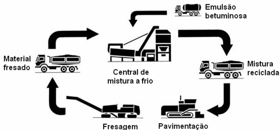
Figura 2.11 – Esquema do processo de reciclagem em central com emulsão betuminosa (adaptado de Wirtgen, 2003)
