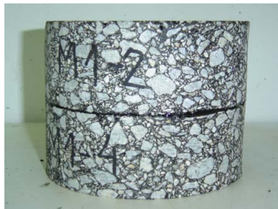
Figura 4.35 – Procedimento de colagem dos provetes das misturas MBLB
