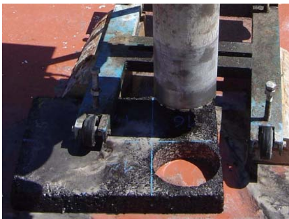
Figura 4.34 – Carotagem das lajes das misturas BDLB e aspecto dos tarolos da mistura R2
