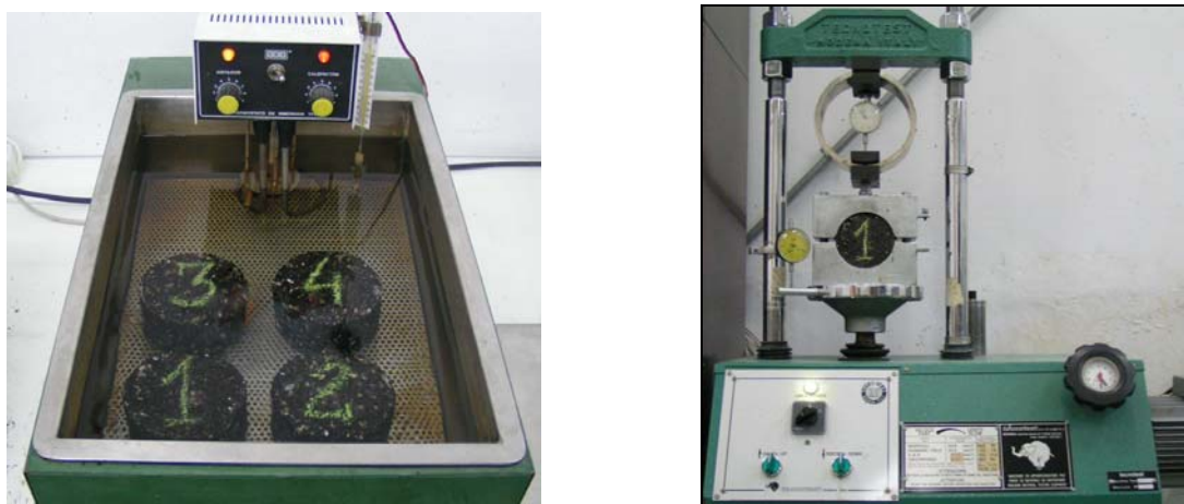
Figura 4.39 – Equipamento para realização do ensaio de compressão Marshall
