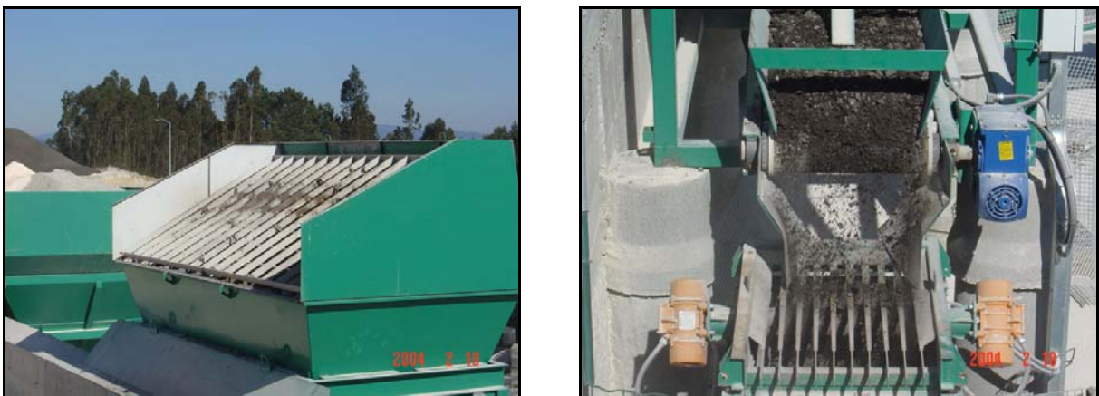
Figura 4.19 – Rejeição de material fresado de maior dimensão
