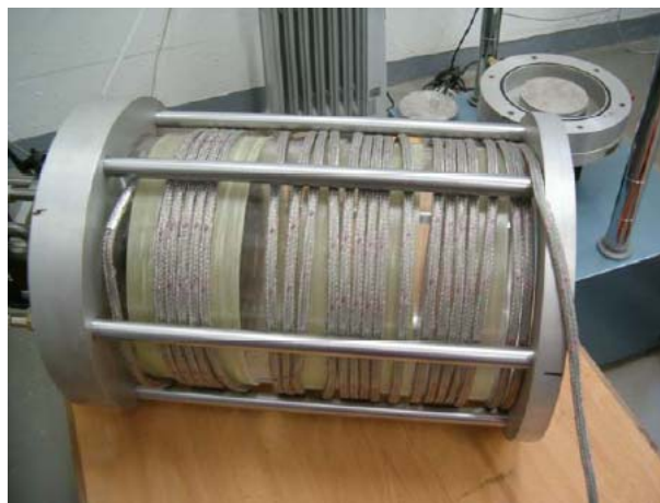
Figura 4.54 – Colocação de uma resistência eléctrica envolvendo a câmara triaxial para controlo da temperatura de ensaio (Gardete, 2005)
