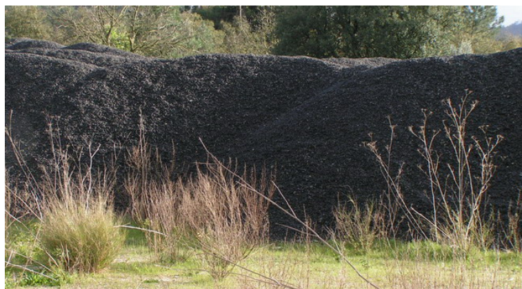
Figura 1.4 – Exemplo de depósito (com mais de cinco anos) de material proveniente de fresagem
