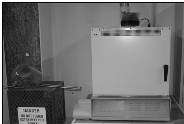
Figura 4.2 – Equipamento usado na determinação da percentagem de betume por incineração
