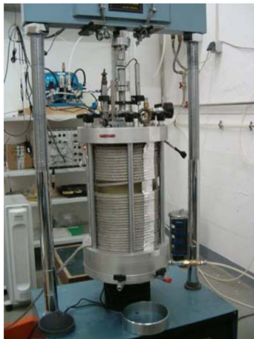
Figura 4.53 – Aspecto do equipamento para realização de ensaios de compressão triaxial (DEC-FCTUC)
