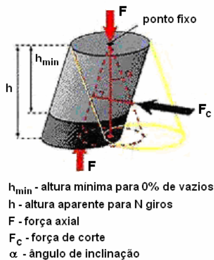
Figura 3.13 – Esquema de funcionamento da prensa de corte giratória (Picado-Santos, 2005, adaptado de LCPC, 2003) e aspecto do equipamento instalado no DEC-FCTUC
