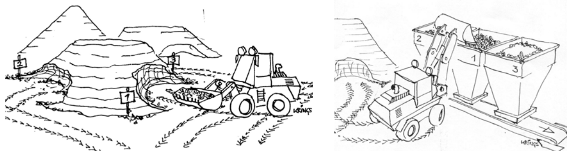
Figura 6.7 – Esquema das pilhas de armazenamento do material fresado por camadas e da introdução na unidade de alimentação (AIPCR, 2003)
