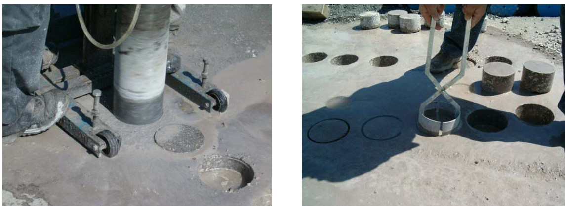
Figura 4.30 – Operações de extracção dos tarolos de 150 mm de diâmetro
