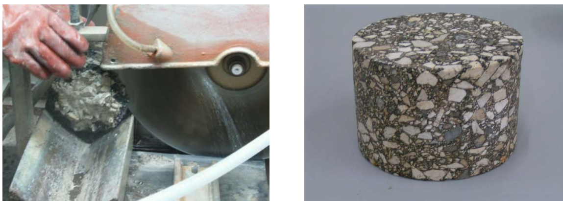
Figura 4.31 – Operação de corte dos tarolos de 150 mm de diâmetro e exemplo de provete após rectificação
