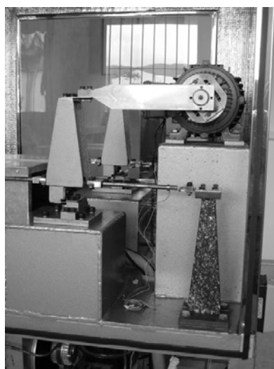
Figura 3.9 – Equipamento para ensaios de flexão da USFC - Brasil (Momm, 2005)
