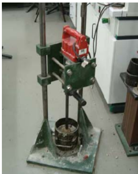
Figura 4.26 – Aspecto do compactador com placa vibratória
