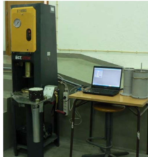
Figura 3.13 – Esquema de funcionamento da prensa de corte giratória (Picado-Santos, 2005, adaptado de LCPC, 2003) e aspecto do equipamento instalado no DEC-FCTUC
