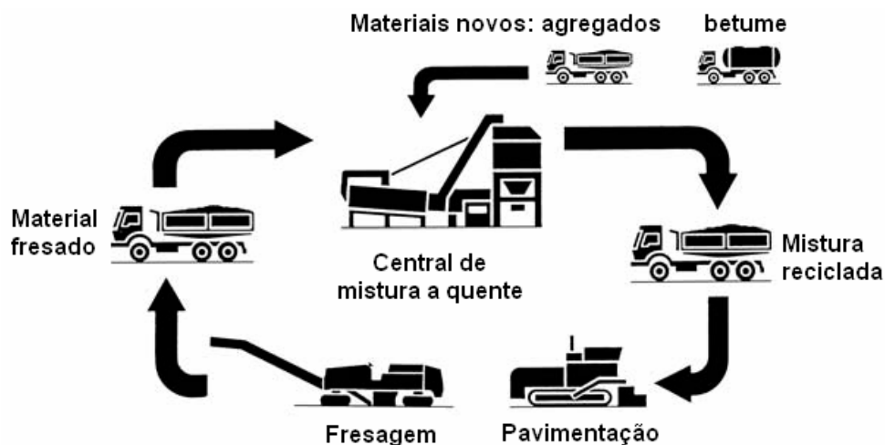
Figura 2.14 – Esquema do processo de reciclagem a quente em central (adaptado de Wirtgen, 2003)
