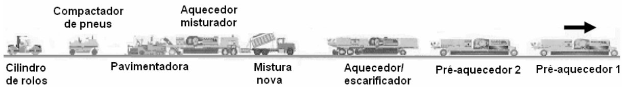
Figura 2.10 – Fases da reciclagem a quente in situ (Martinho e Picado-Santos, 2006)
