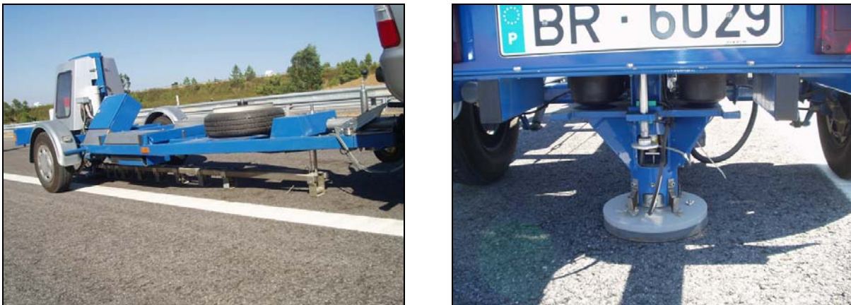
Figura 4.57 – Aspecto do deflectómetro de impacto, UC-UM
