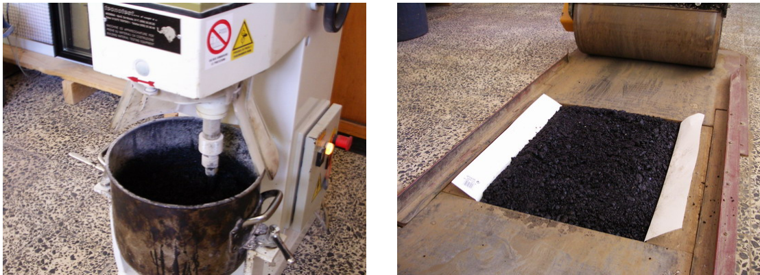
Figura 4.25 – Aspecto das operações de mistura e compactação em laboratório (lajes)
