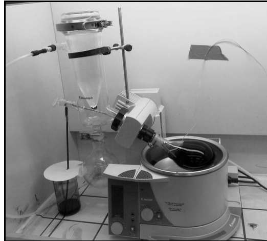
Figura 4.4 – Evaporador rotativo usado na recuperação de betume
